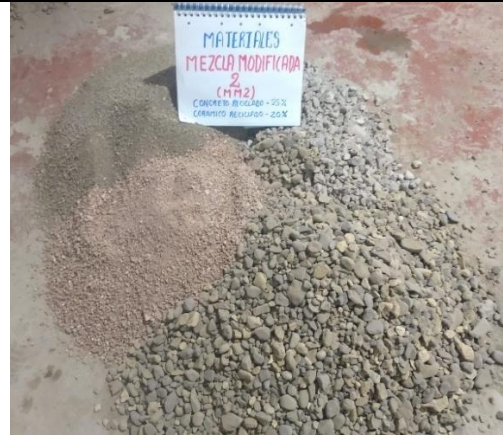
Figura 11. Mezcla de materiales
