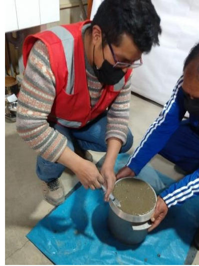
Figura 18. Ensayo de exudación del concreto fresco – extracción de agua
