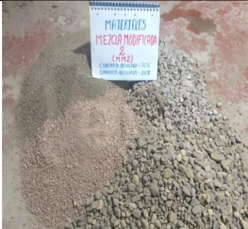
Figura 09. Elaboración del concreto – mezcla de materiales
