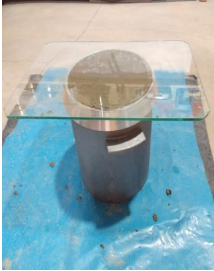
Figura 17. Ensayo de exudación del concreto fresco – anti evaporación
