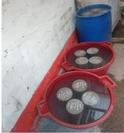
Figura 13. Curado de las probetas de concreto
