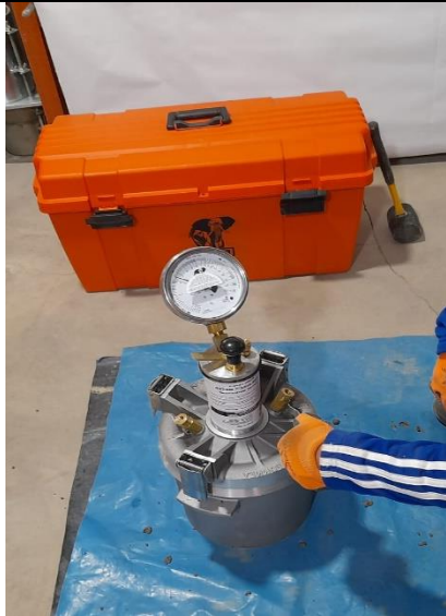
Figura 21. Ensayo de contenido de aire en concreto fresco
