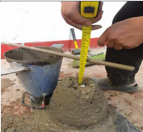
Figura 12. Ensayo de asentamiento cono de abrams
