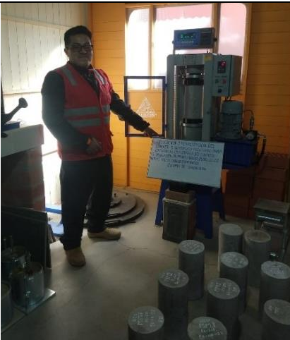
Figura 15. Ensayo de compresión del concreto
