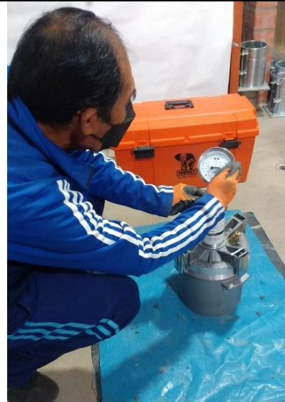
Figura 22. Ensayo de contenido de aire en concreto fresco
