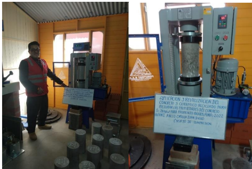
Figura 31. Ensayo de compresión del concreto
