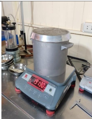
Figura 17. Peso del concreto fresco
