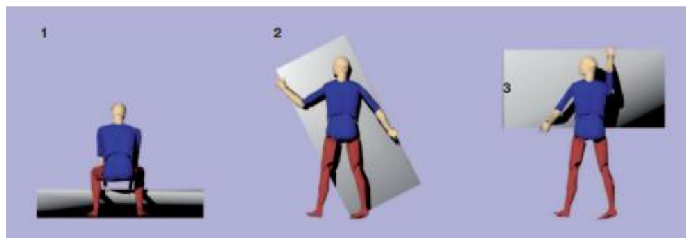
Figura 7. Sistema de levantamiento con 3 puntos de apoyo
