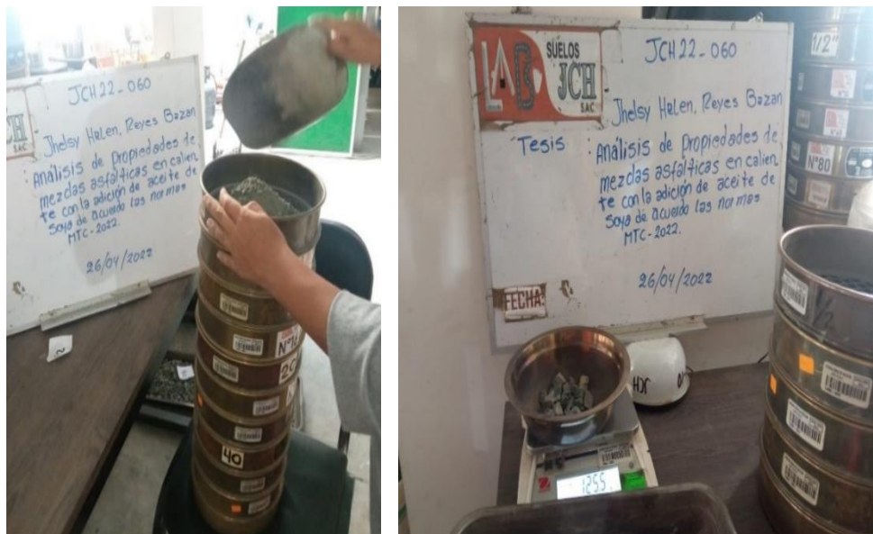
Figura 4. Análisis granulométrico de agregados, tamizaje y pesaje de material retenido.
