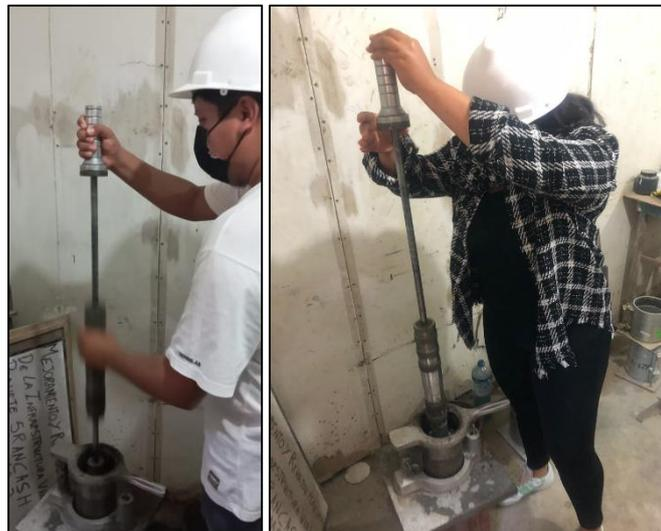
Foto N°11: Compactación de núcleos de la mezcla asfáltica modificada.
