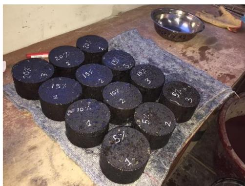
Foto N°12: Núcleos de la mezcla asfáltica modificada con la melaza.
