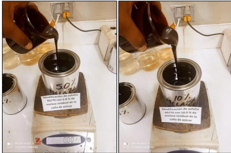
Foto N°04: Combinación del cemento asfáltico y la melaza.
