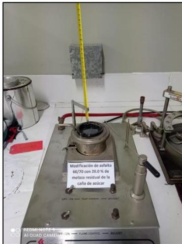
**Foto N°08:** Ensayo de Punto de inflamación.
