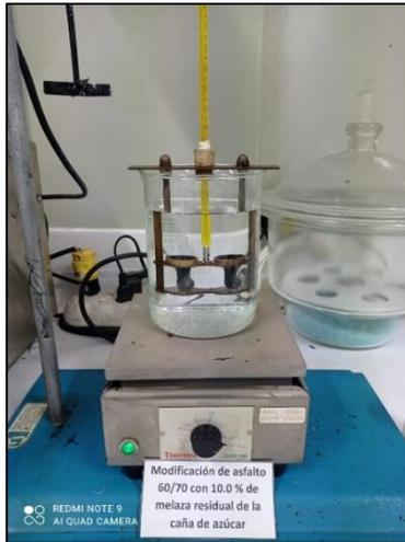
**Foto N°07:** Ensayo de Punto de ablandamiento.
