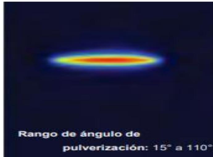
Figura 26. Espectro de chorro de boquilla plana
