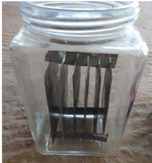
Figura 45. Celda de prototipo de electrocoagulación
