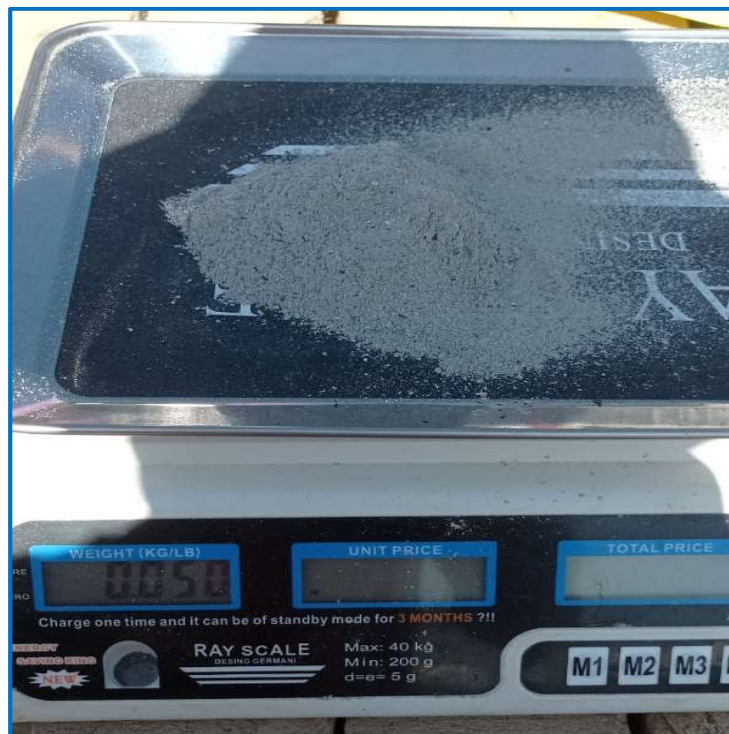
Figura N°38: Pesaje de ceniza al 1.0% con respecto al peso seco del suelo.
