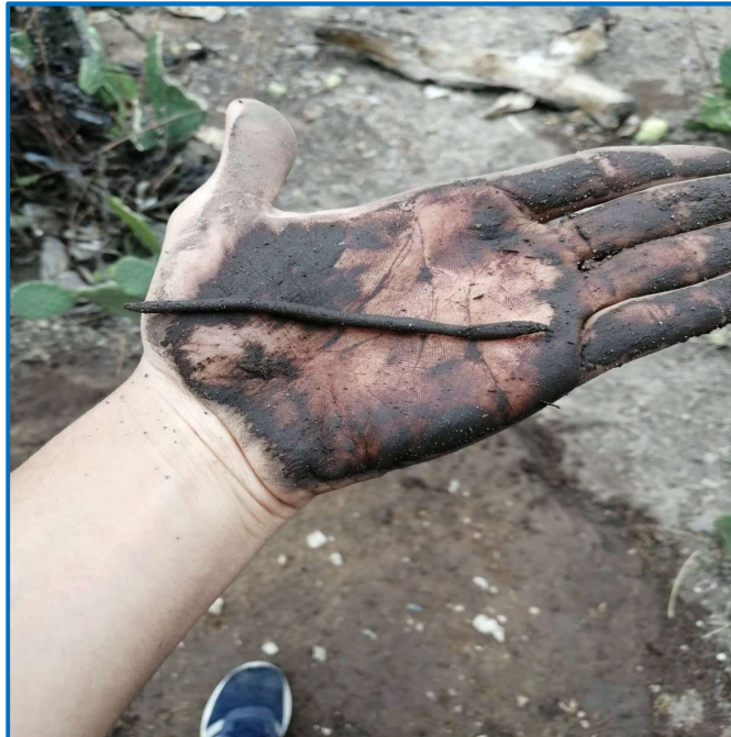
Figura N°04: Pruebas de cinta de barro.
