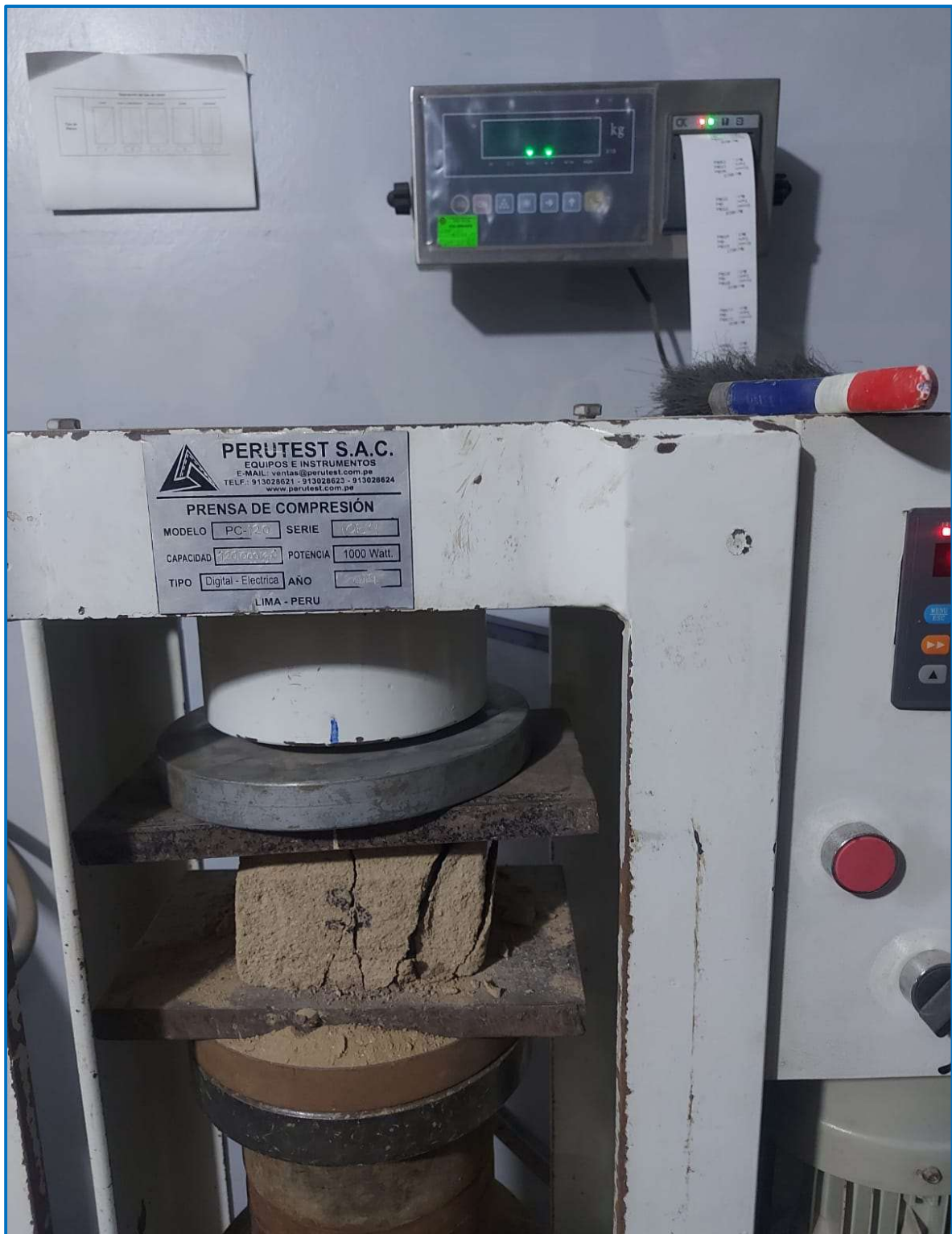
Figura N°45: Ensayo de resistencia a compresión.
