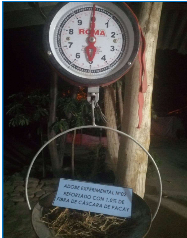
Figura N°33: Pesaje de fibra al 1.0% con respecto al peso seco del suelo.
