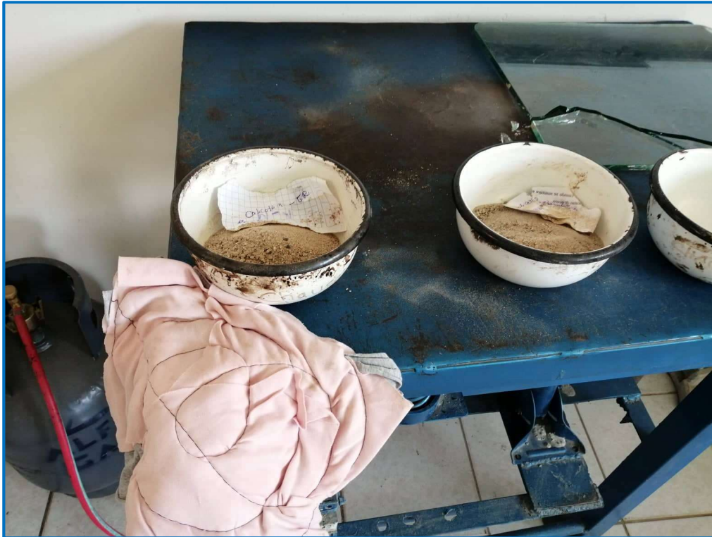
Figura N°09: Obtención de muestra seca para porcentaje de humedad.
