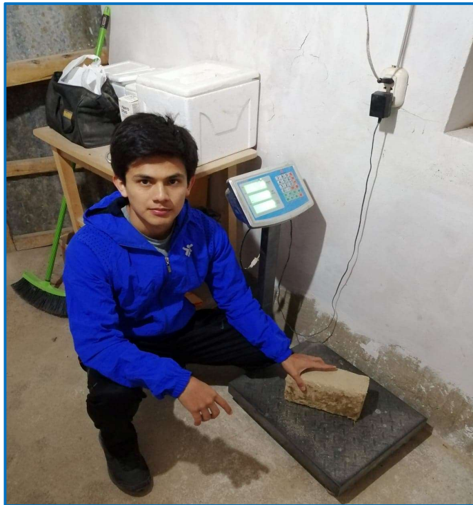
Figura N°24: Obtención de peso seco de adobe simple.
