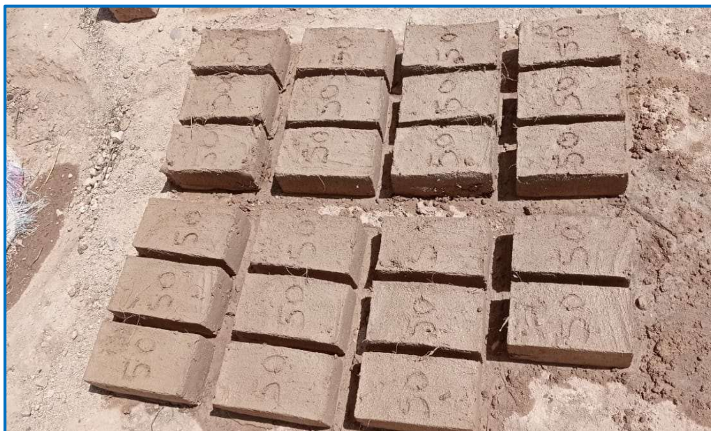
Figura N°40: Elaboración de bloques de adobe con ceniza de cáscara de pacay.
