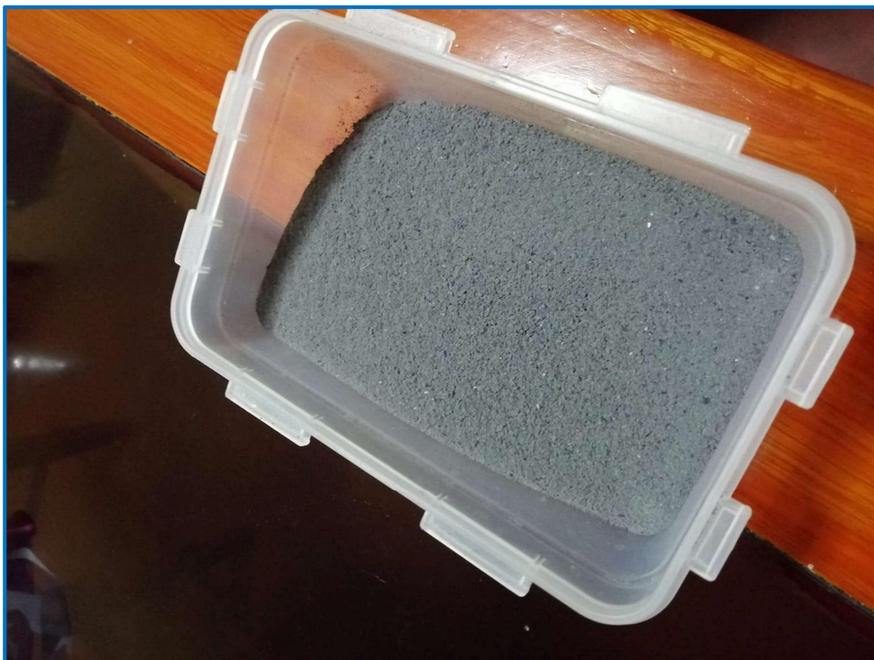
Figura N°16: Obtención de muestra para ensayo de fluorescencia.
