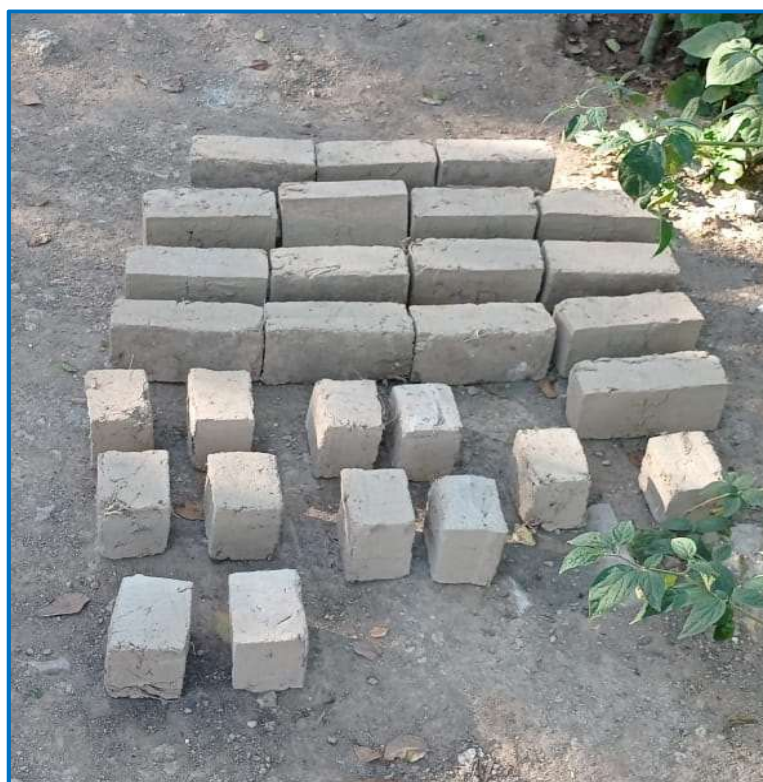
Figura N°42: Cubos de 10 cm de arista para ensayo de resistencia a compresión.
