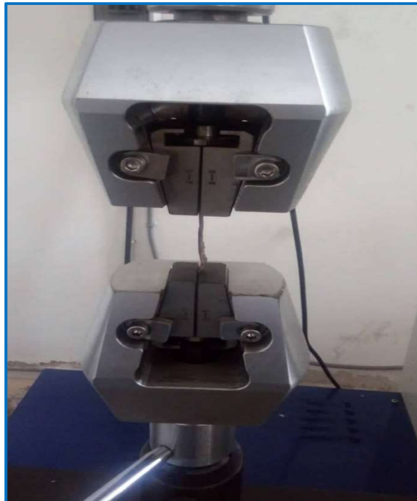
Figura N°22: Ensayo de tracción para fibra de cáscara de pacay.
