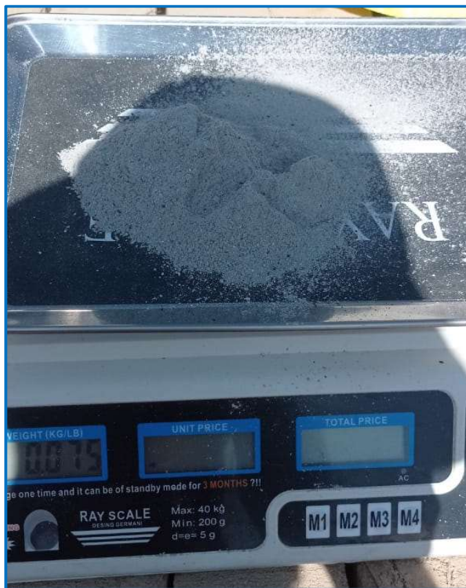
Figura N°39: Pesaje de ceniza al 1.5% con respecto al peso seco del suelo.
