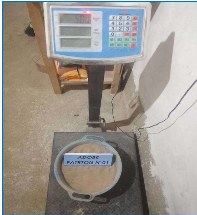
Figura N°25: Pesaje de suelo para cada unidad de adobe patrón.
