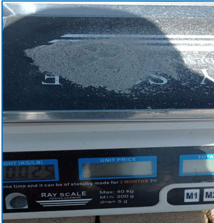
Figura N°37: Pesaje de ceniza al 0.5% con respecto al peso seco del suelo.
