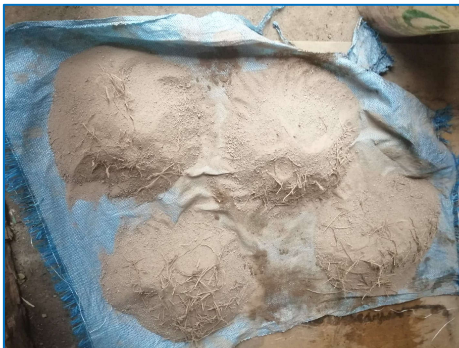
Figura N°35: Adición de fibra de cáscara de pacay.
