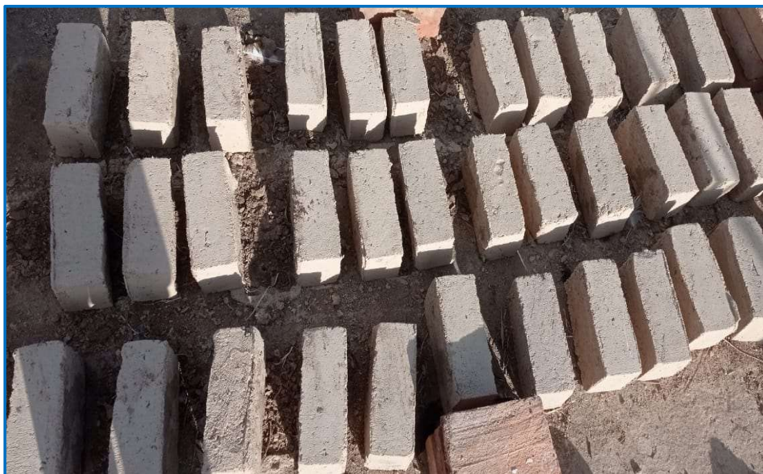
Figura N°41: Secado de bloques de adobe.
