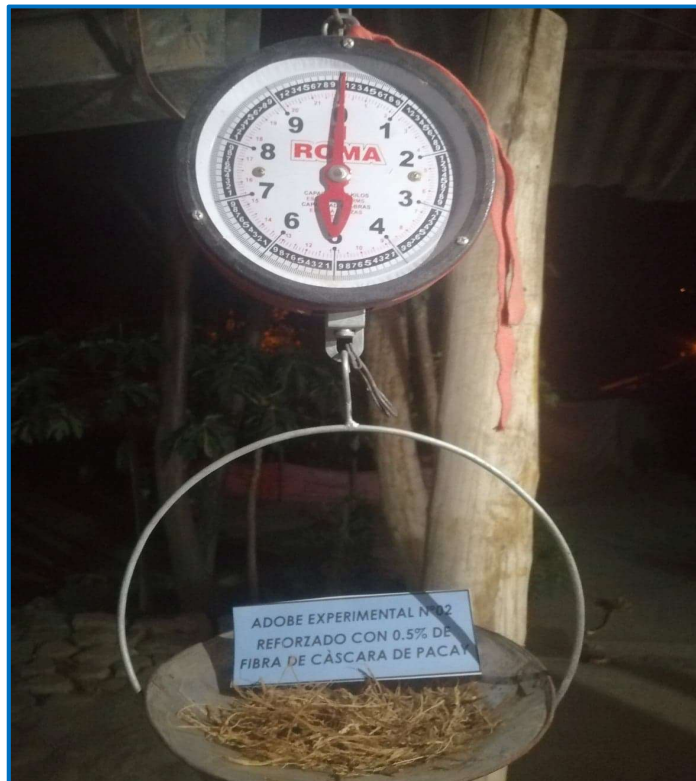
Figura N°32: Pesaje de fibra al 0.5% con respecto al peso seco del suelo.
