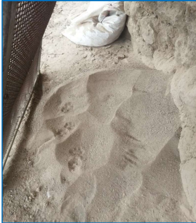
Figura N°23: Tamizado de suelo para la elaboración de bloques de adobe.
