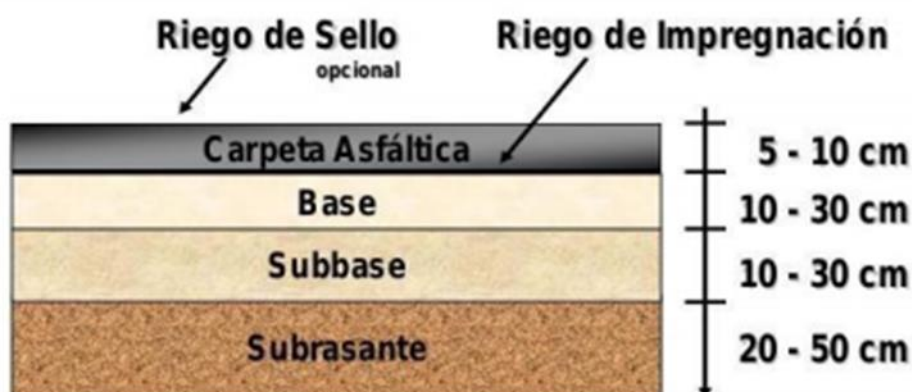
Figura 1. Estructura de un pavimento
