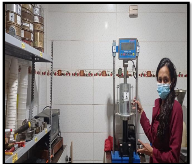
Ensayo de CBR
