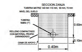
DETALLE 01: CONEXION A RED PUBLICA ESC. = S/E
