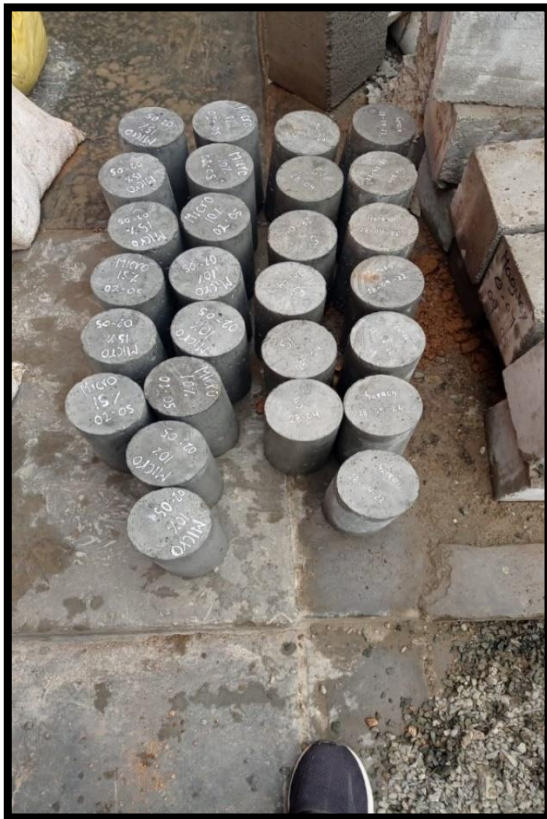
Figura 24. Curado de probetas y vigas a los 7 y 28 días. Elaboración propia
