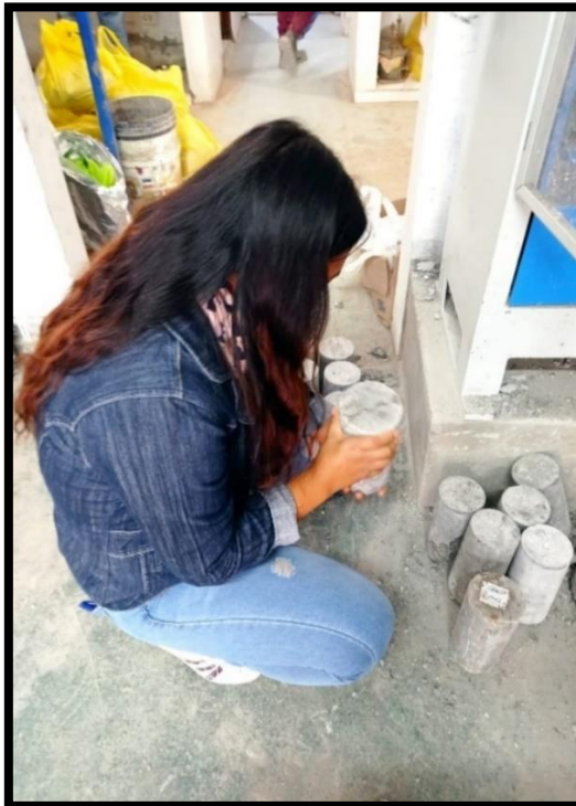
Figura 25. Ruptura de probetas a los 7 días. Elaboración propia
