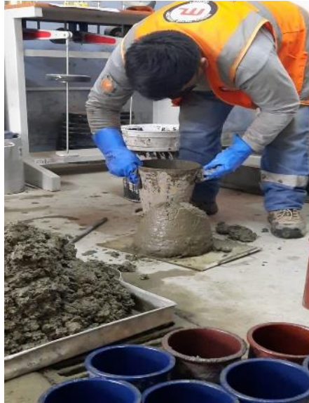
Figura 6. Asentamiento de la muestra patrón se puede visualizar que la muestra logra una mezcla trabajable. Fuente: Elaboración Propia.
