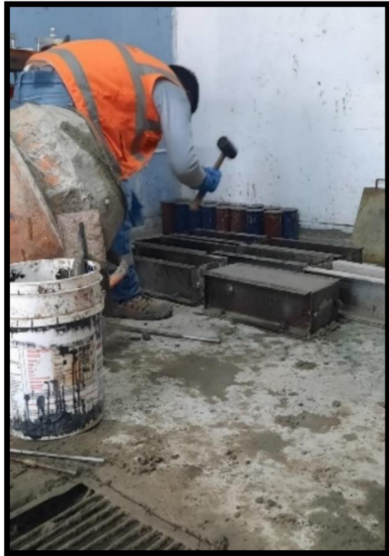
Figura 22. Colocación de la mezcla en las probetas con sus respectivos 25 golpes que indica la norma. Elaboración propia
