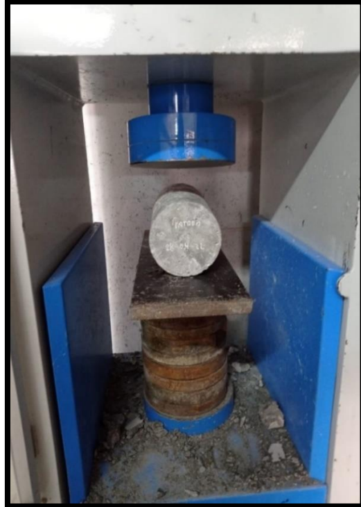
Figura 25. Ruptura de probetas a los 7 días. Elaboración propia
