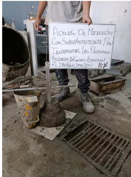
Figura 8. Asentamiento de la muestra del SF 10% y SP 1% se puede visualizar que se logra una mezcla trabajable. Fuente: Elaboración Propia.
