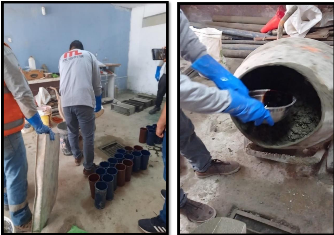
Figura 19. Peso del cemento, agregados fino y gruesos para la elaboración del concreto estructural. Elaboración propia
