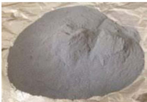
Figura 2. La Microsílice posee un color gris oscuro y es ultrafino. Tomada de Toxement, 2016.
