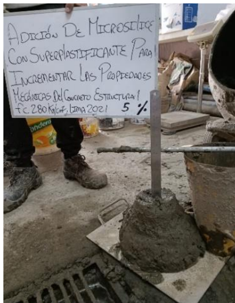
Figura 7. Revenimiento de la muestra del SF 5% y SP 1% se puede visualizar que la muestra logra una mezcla muy trabajable con la incorporación de microsíllice con superplastificante. Fuente: Elaboración Propia.
