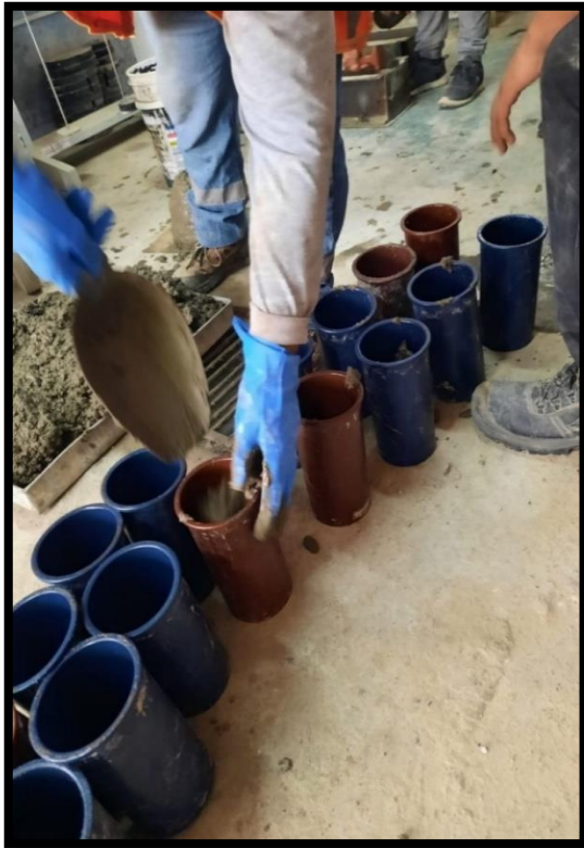
Figura 22. Colocación de la mezcla en las probetas con sus respectivos 25 golpes que indica la norma. Elaboración propia
