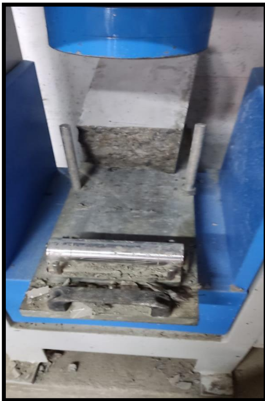
Figura 27. Ruptura de vigas a los 7 y 28 días. Elaboración propia
