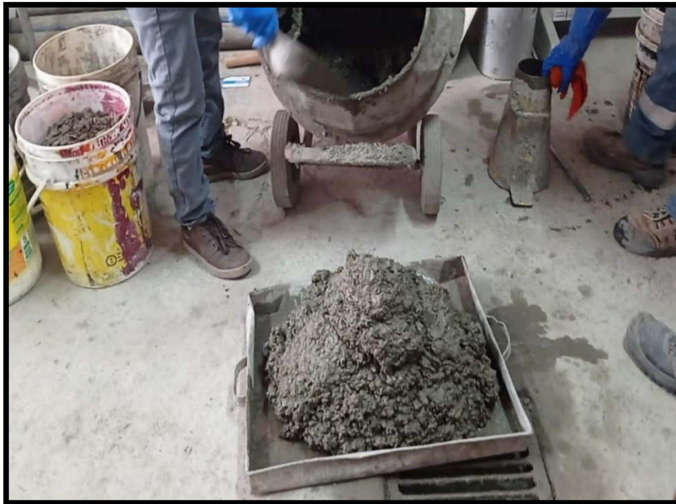
Figura 21. Retiro de la mezcla del trompo girador. Elaboración propia
