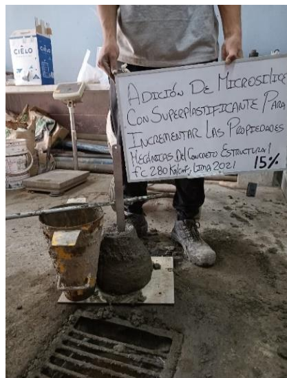
Figura 9. Revenimiento de la muestra del SF 15% y SP 1% se puede visualizar que se logra una mezcla trabajable. Fuente: Elaboración Propia.
