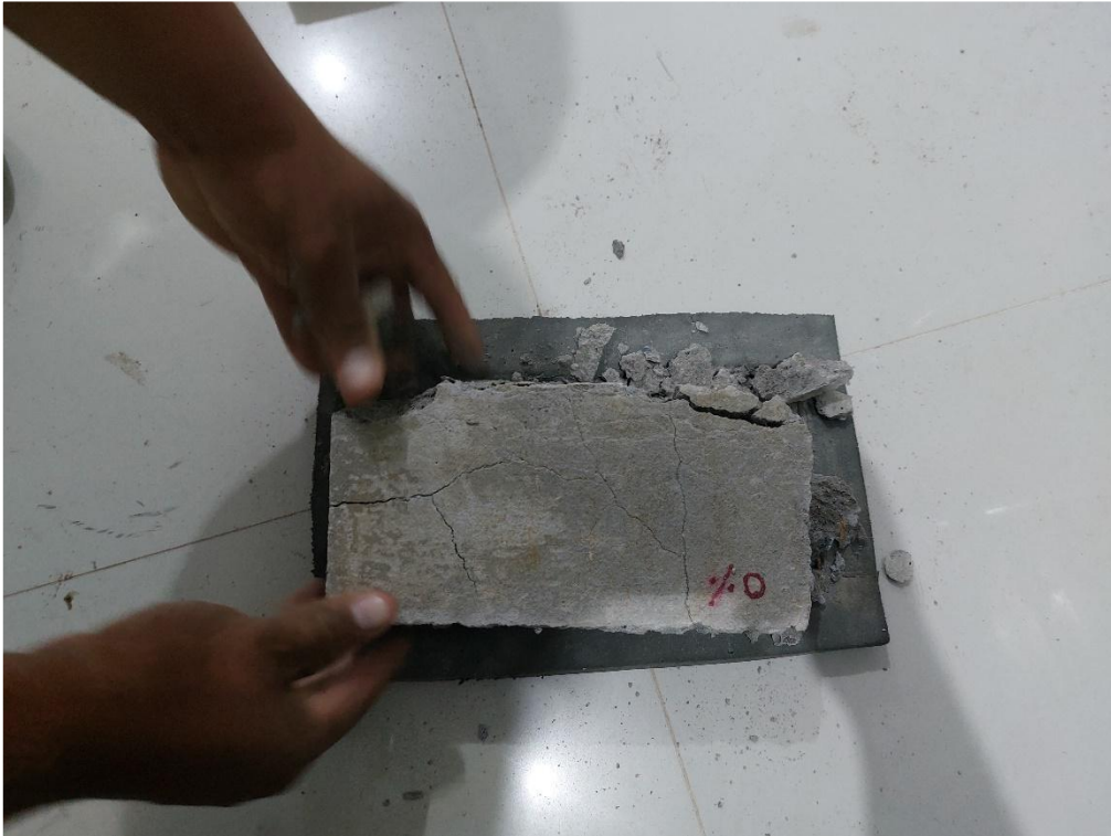
Anexo 24: Panel Fotográfico N° 11: Adoquines después de la rotura.
