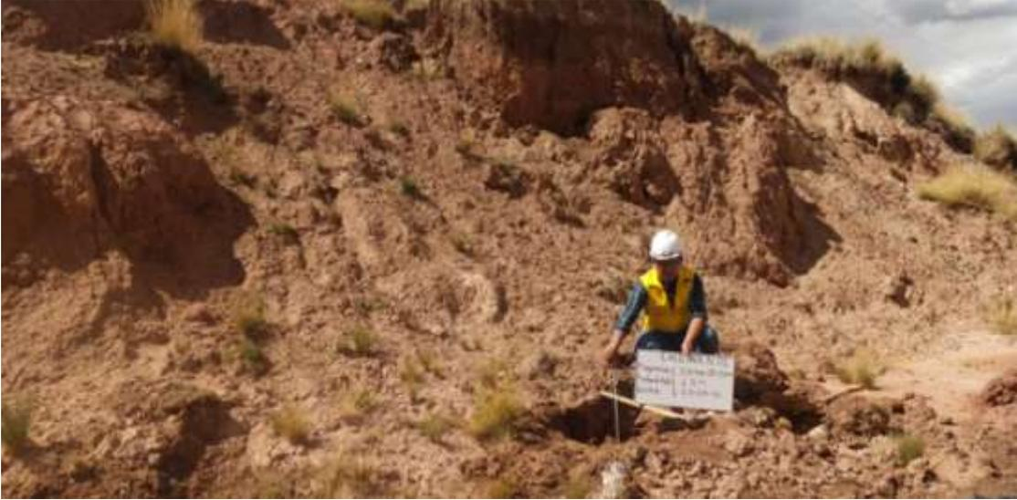
Fig. 01. Obtención de muestra de la calicata 01 progresiva km 33+605 a km 33+776.
