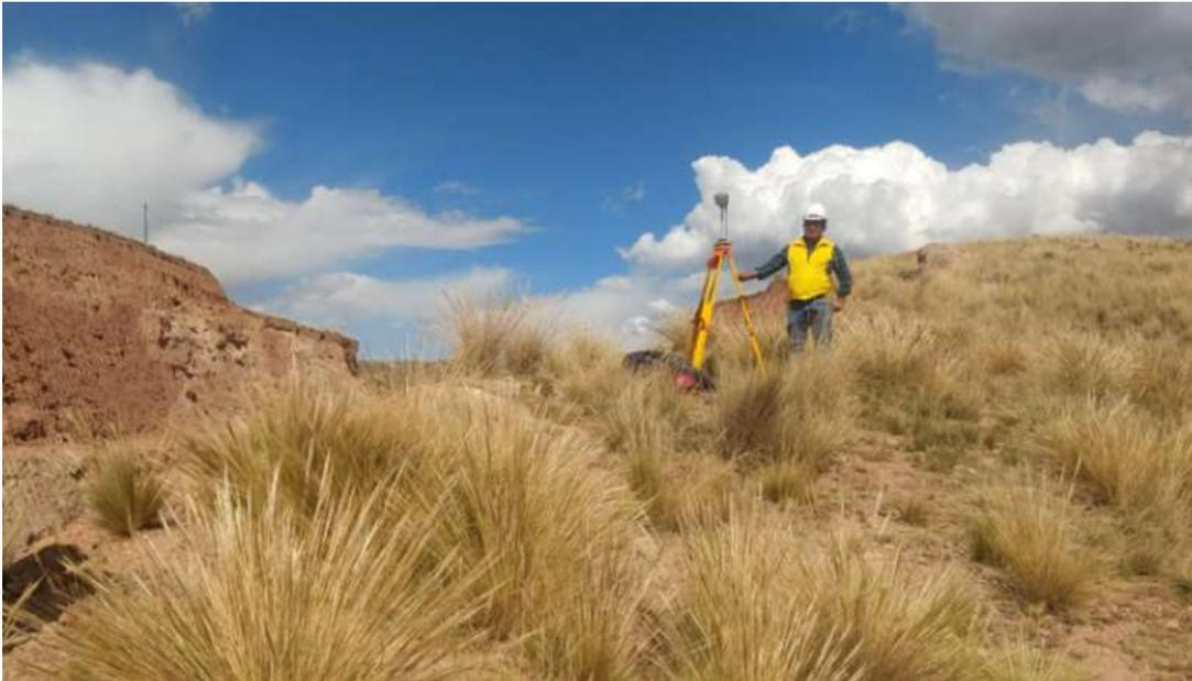
Fig. 03. Levantamiento con GPS diferencia Galaxy G1 km 33+605 a km 33+776.
