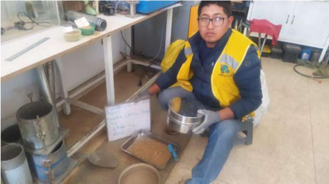
Fig. 05. Tamizado de muestras para limite plástico.
