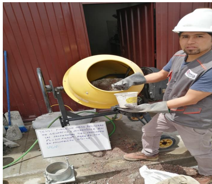
Figura 14. Elaboración del diseño de mezcla con adición de fibra de acero y microsílíce
