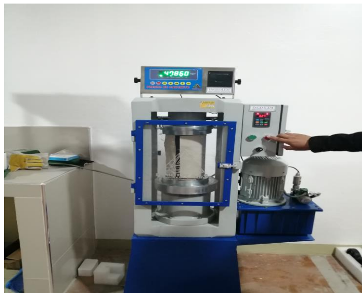
Figura 23. Preparación de la prensa de rotura de concreto
