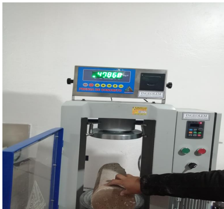
Figura 26. Preparación de la prensa de rotura de concreta tracción
