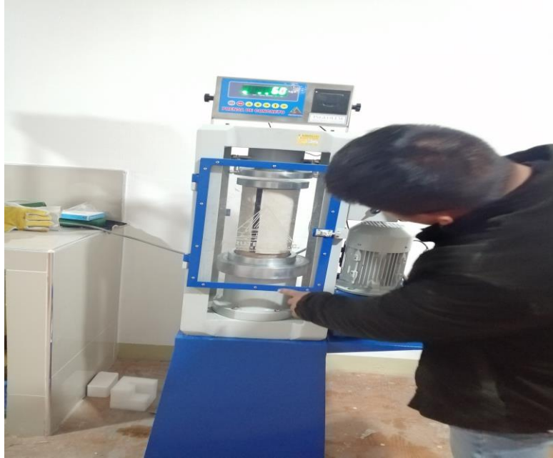
Figura 22. Preparación de la prensa de rotura de concreto
