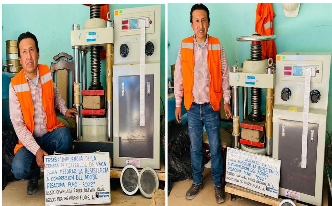
**Figura 31:** Prueba a la resistencia a la compresión de la unidad de adobe con 2% de ceniza de estiércol de vaca.
