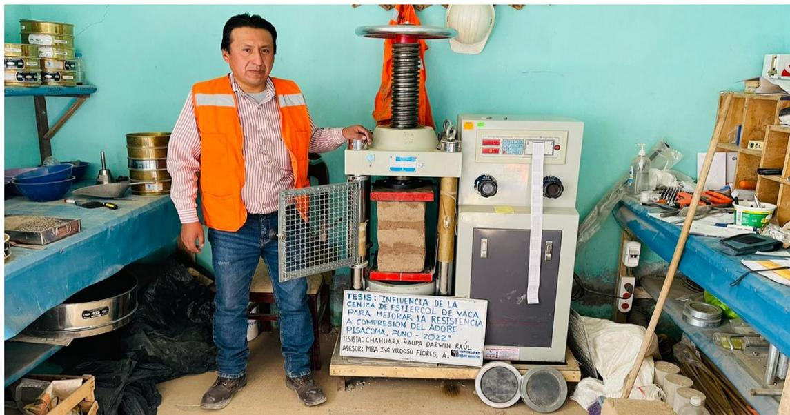
**Figura 39:** Prueba a la resistencia a la compresión axial de pilas de adobe con 9% de ceniza de estiércol de vaca.
