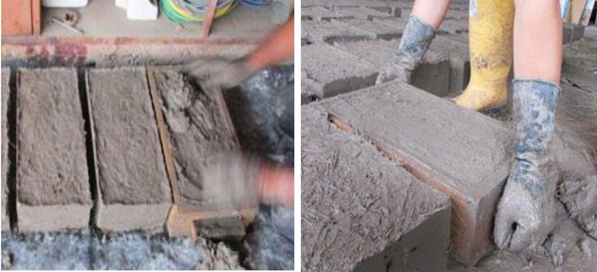
**Figura 19:** Moldeado y desmoldeado
