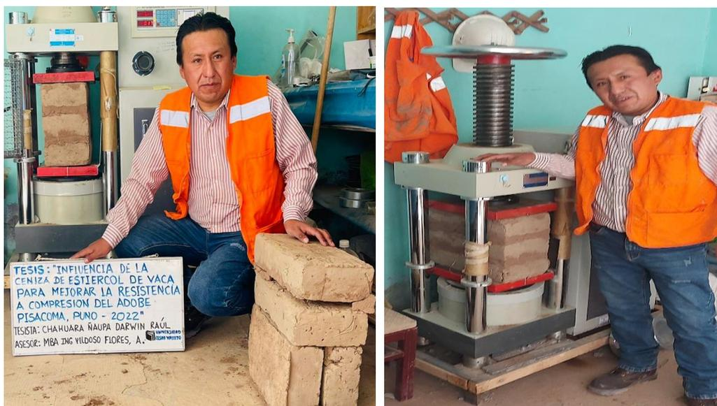
**Figura 37:** Prueba a la resistencia a la compresión axial de pilas de adobe con 2% de ceniza de estiércol de vaca.
