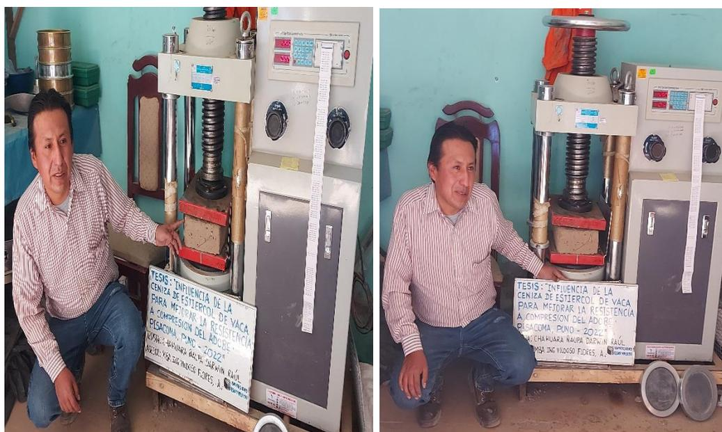
**Figura 34:** Prueba a la resistencia a la compresión de la unidad de adobe patrón.
