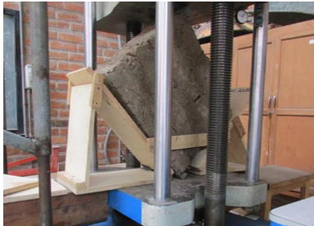
**Figura 48:** Prueba a la resistencia a la compresión diagonal de los muretes de adobe con 2% de ceniza de estiércol de vaca.
