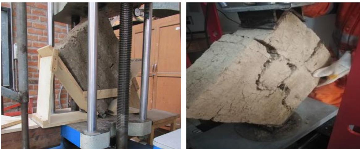
**Figura 45:** Prueba a la resistencia a la compresión diagonal de los muretes de adobe con 2% de ceniza de estiércol de vaca.
