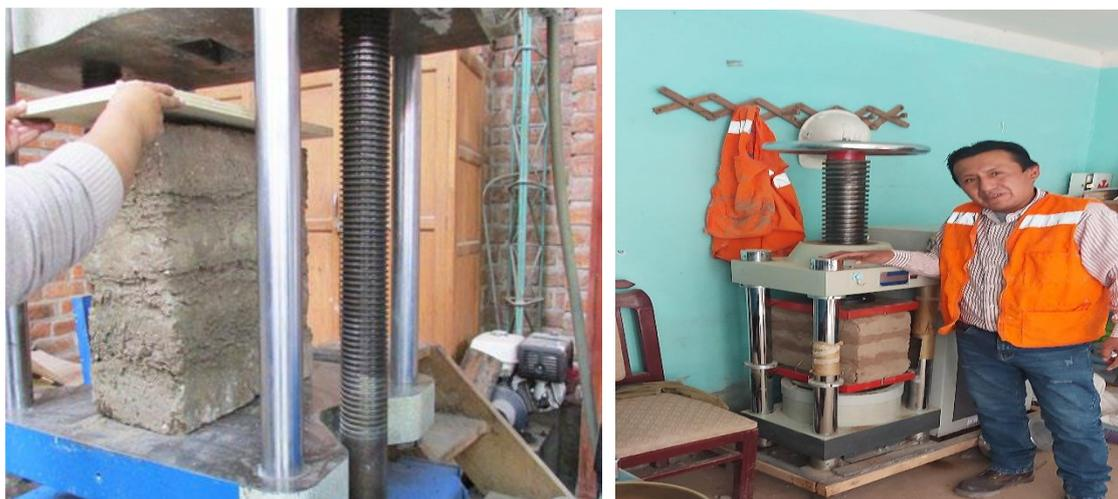
**Figura 40:** Prueba a la resistencia a la compresión axial de pilas de adobe patrón.
