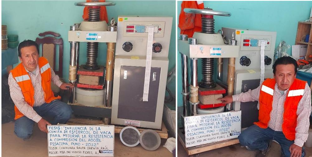
**Figura 23:** Prueba a la resistencia a la compresión de la unidad de adobe.
