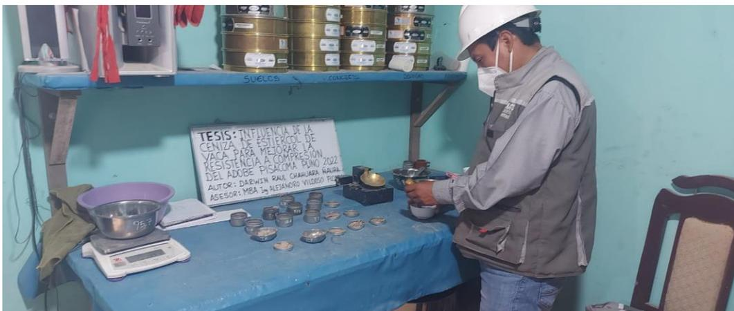
**Figura 10:** Muestra para el ensayo de Atterberg
