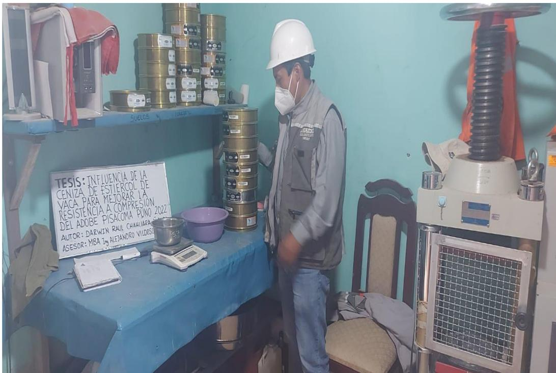
**Figura 6:** Proceso de tamizado de muestra de suelo de la cantera seleccionada
