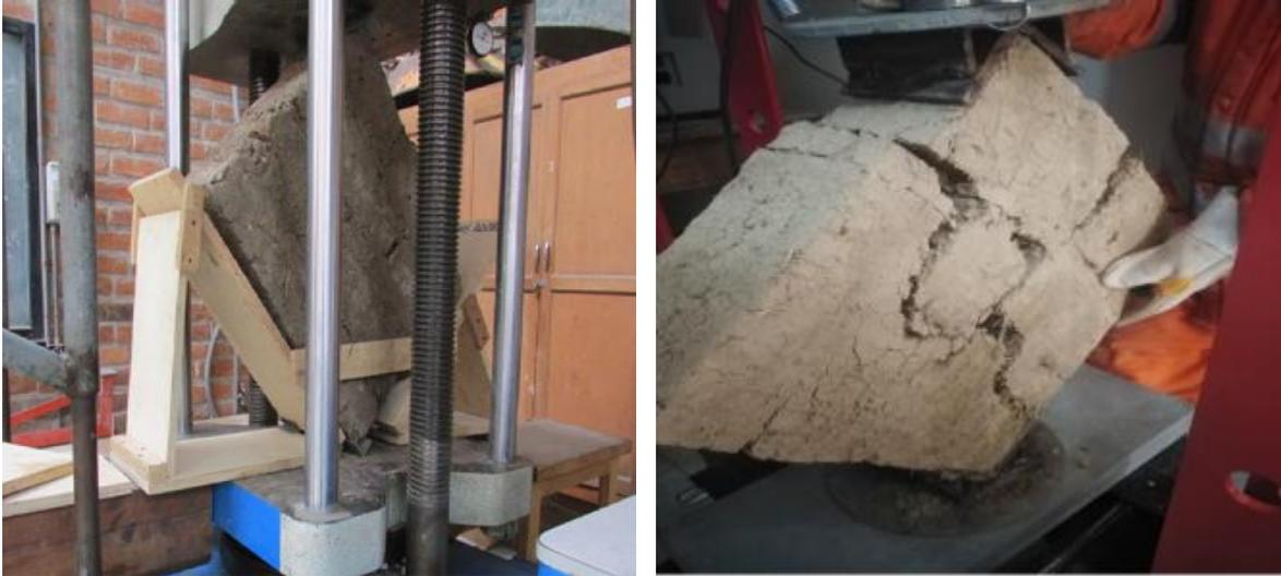
**Figura 25:** Prueba a la resistencia a la compresión diagonal de muretes de adobe.
