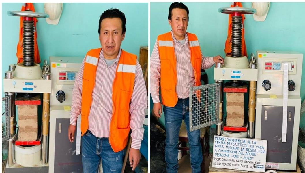
**Figura 38:** Prueba a la resistencia a la compresión axial de pilas de adobe con 5% de ceniza de estiércol de vaca.
