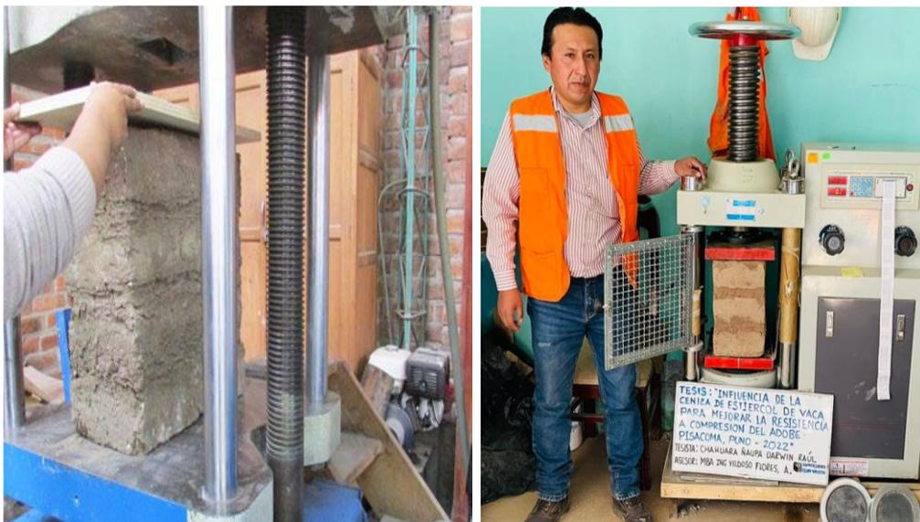
**Figura 24:** Prueba a la resistencia a la compresión de pilas de adobe.
