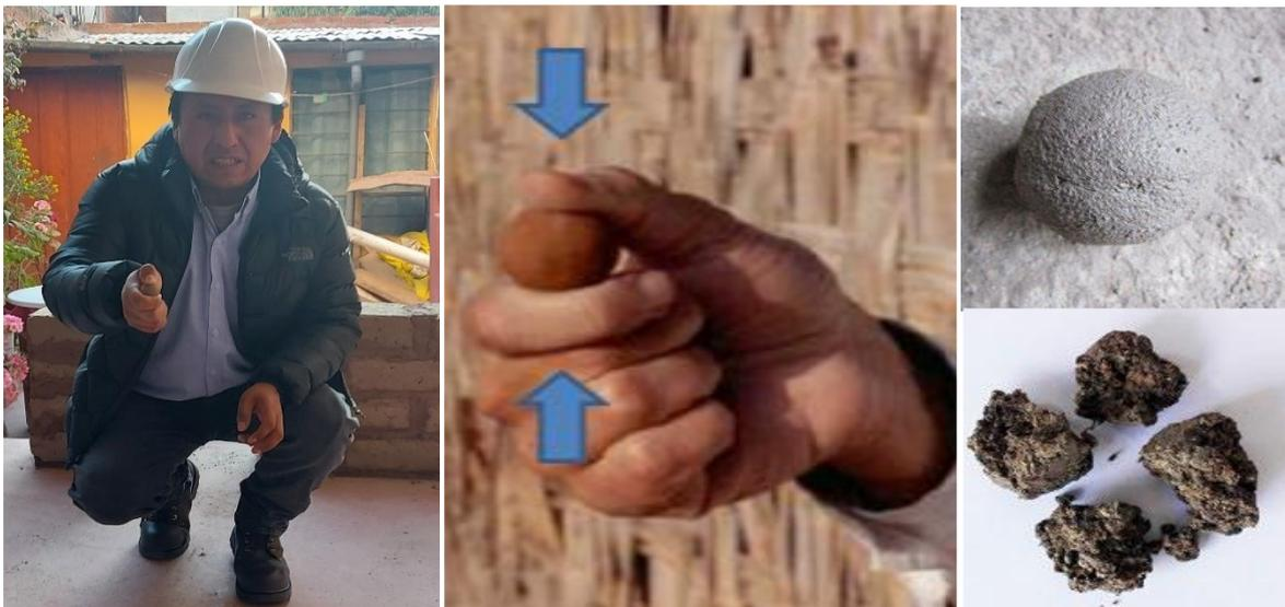
**Figura 5:** Ensayo de campo de “Resistencia Seca”
