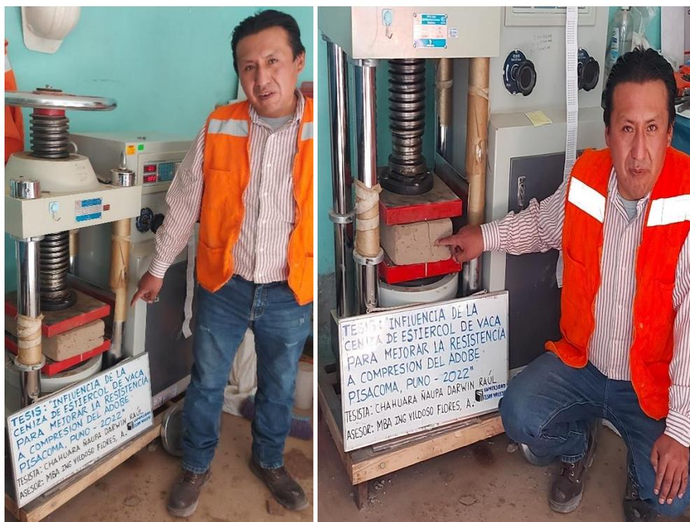
**Figura 33:** Prueba a la resistencia a la compresión de la unidad de adobe con 9% de ceniza de estiércol de vaca.
