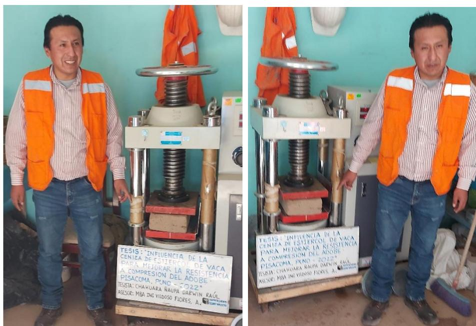
**Figura 32:** Prueba a la resistencia a la compresión de la unidad de adobe con 5% de ceniza de estiércol de vaca.
