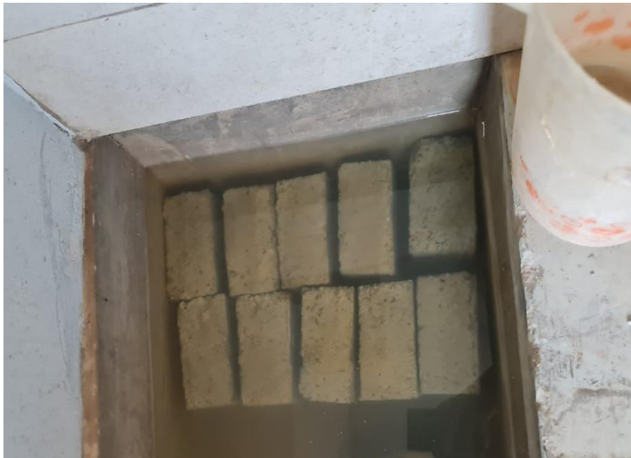
Absorción de ladrillos de concreto patrón y sustitución de 5%, 12% y 18%.
