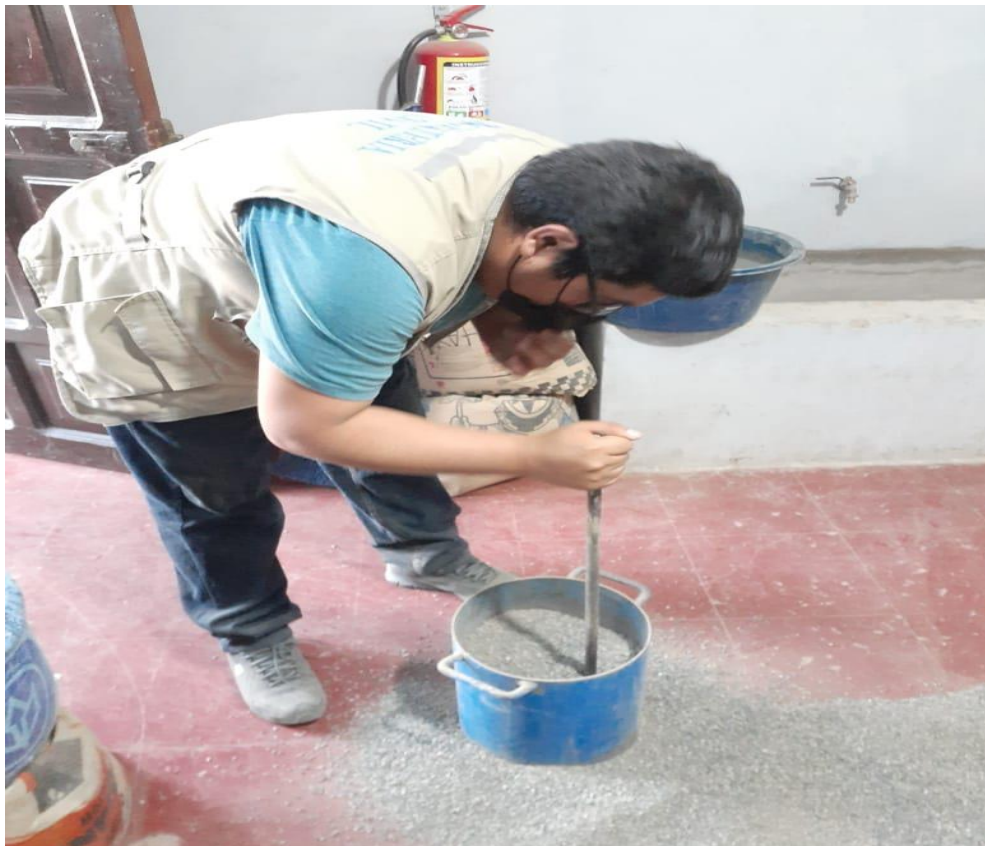
Ensayo de peso unitario de agregado grueso.
