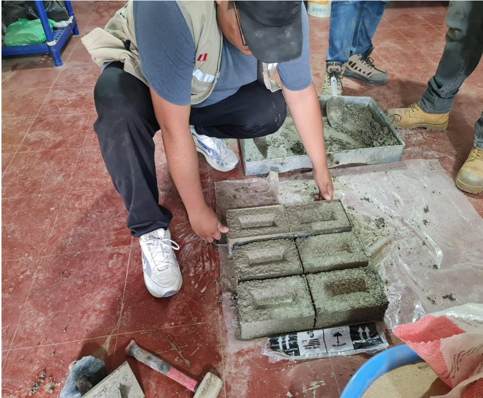
Elaboración de ladrillos de concreto patrón y sustitución de 5%, 12% y 18%.
