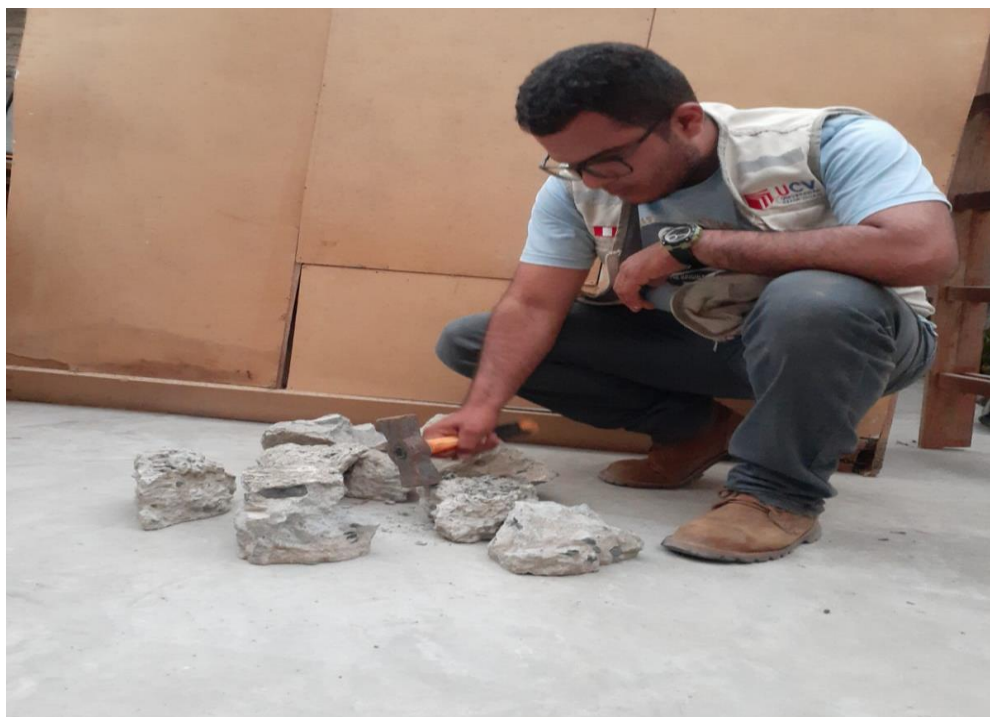
Trituración de concreto reciclado en transformación de agregado fino.
