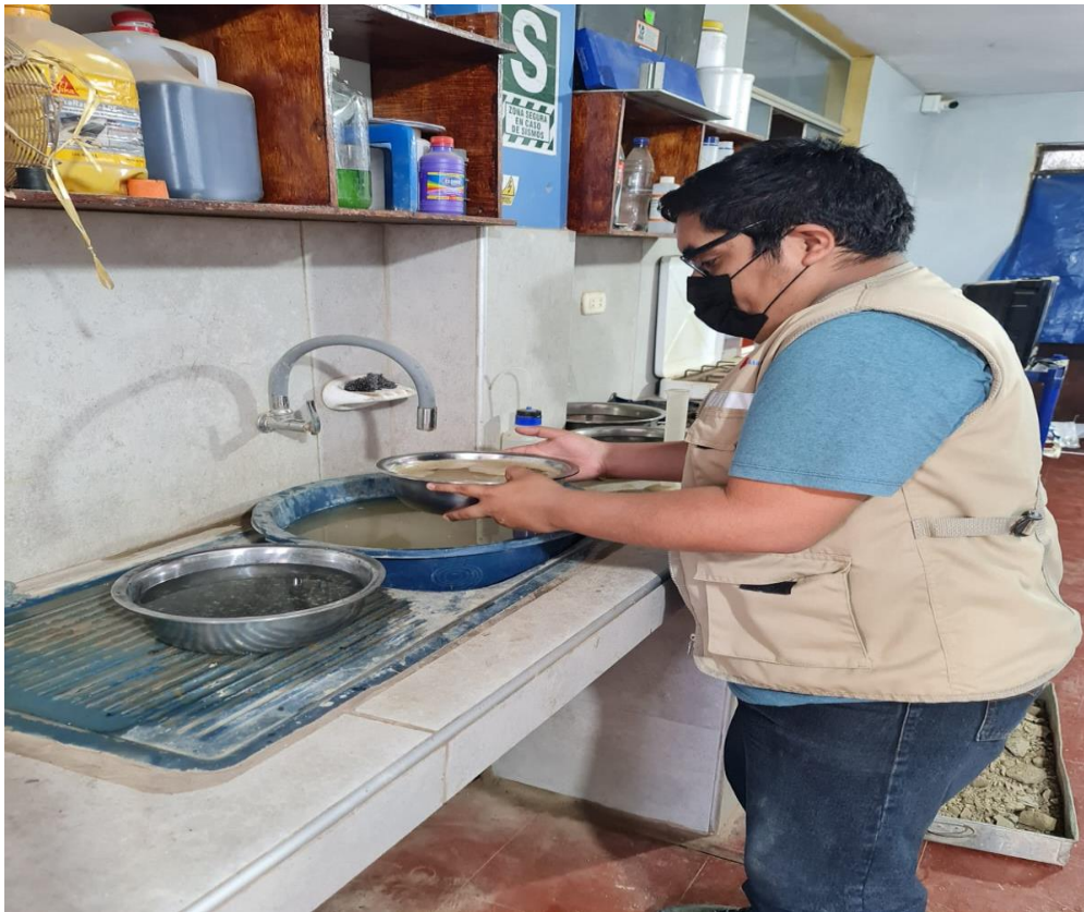
Peso específico y absorción del agregado fino.
