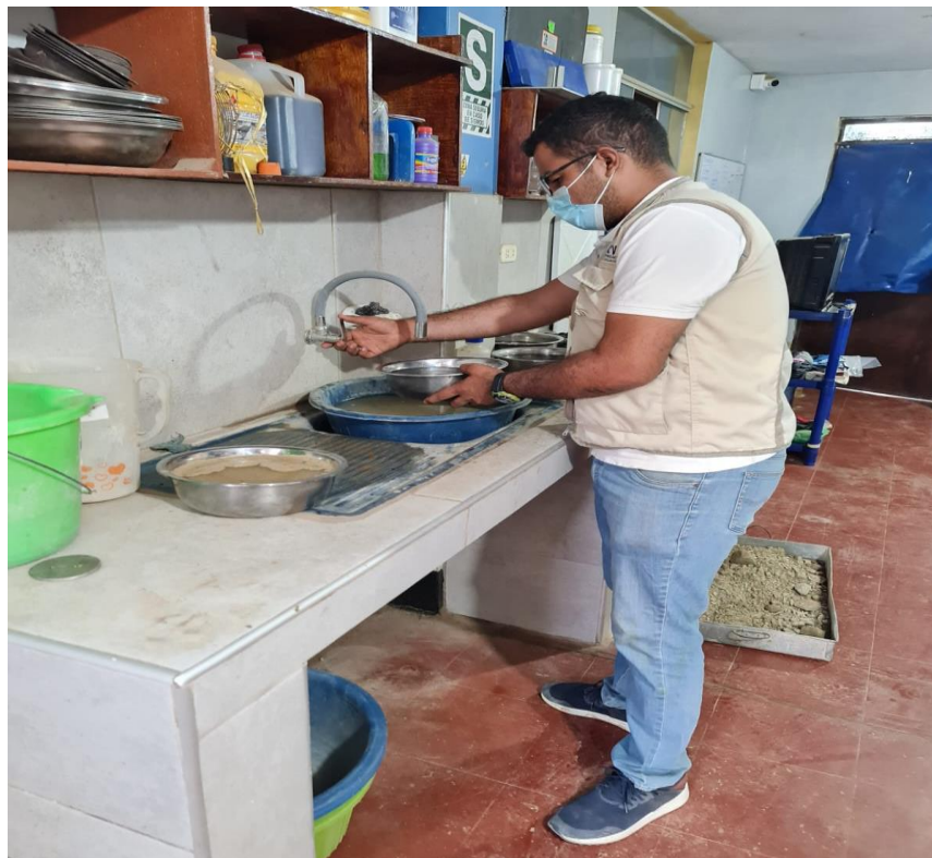
Peso específico y absorción de agregado grueso.
