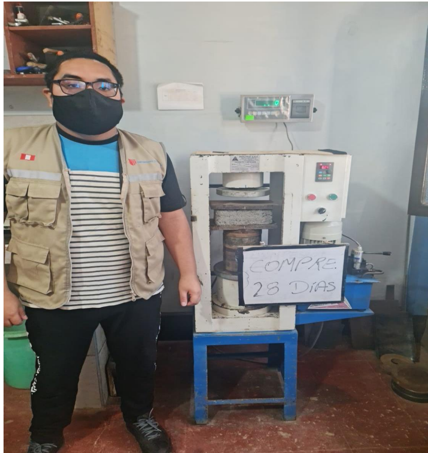
Resistencia a la compresión de ladrillos de concreto patrón y sustitución de 5%, 12% y 18% a los 28 días.
