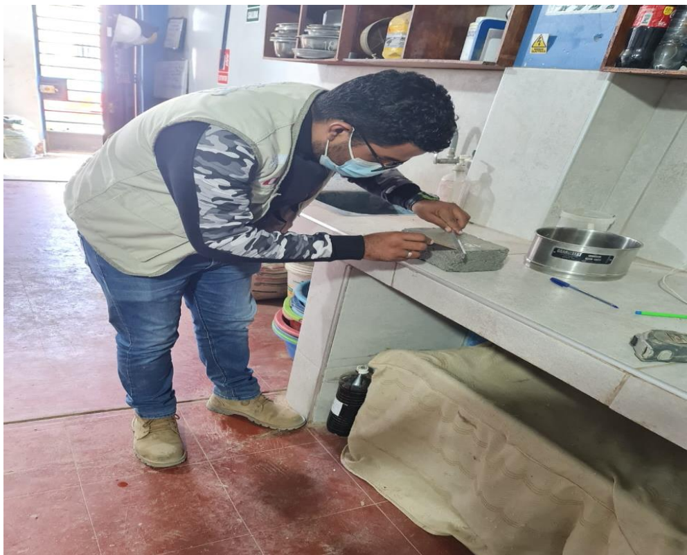
Alabeo de ladrillo de concreto patrón.
