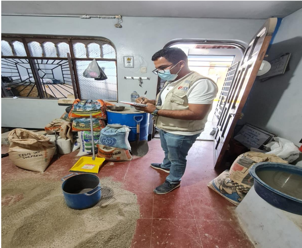
Ensayo de peso unitario de agregado fino.
