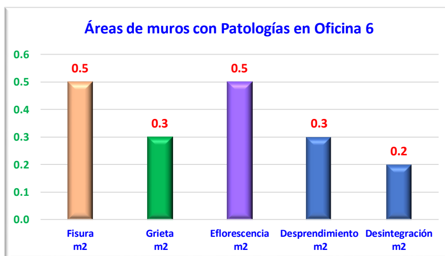
Figura 31. Área con presencia de patologías en muros en la oficina 6
