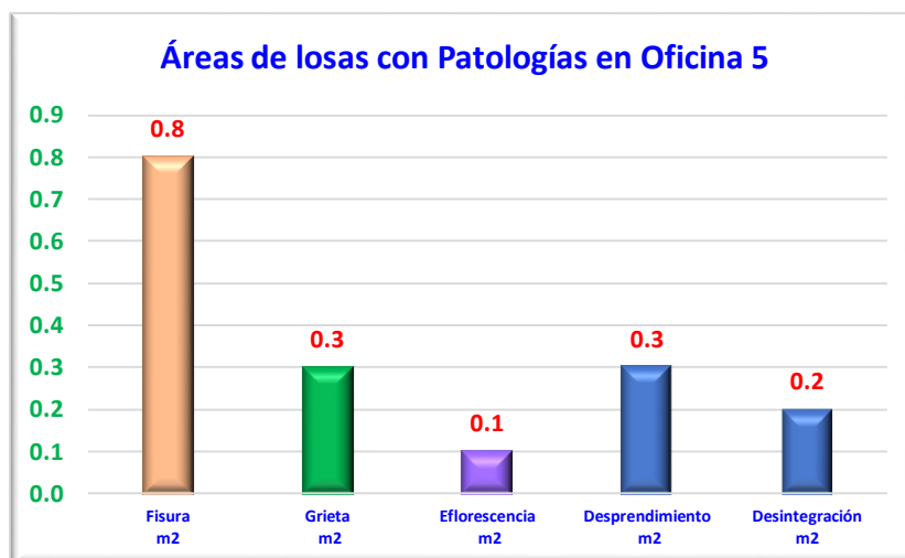
Figura 28. Área con presencia de patologías en losas en la oficina 5
