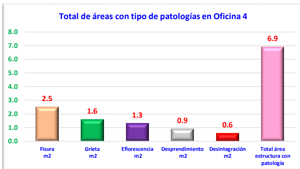
Figura 24. Áreas totales por tipos de patologías encontradas en la oficina 4
