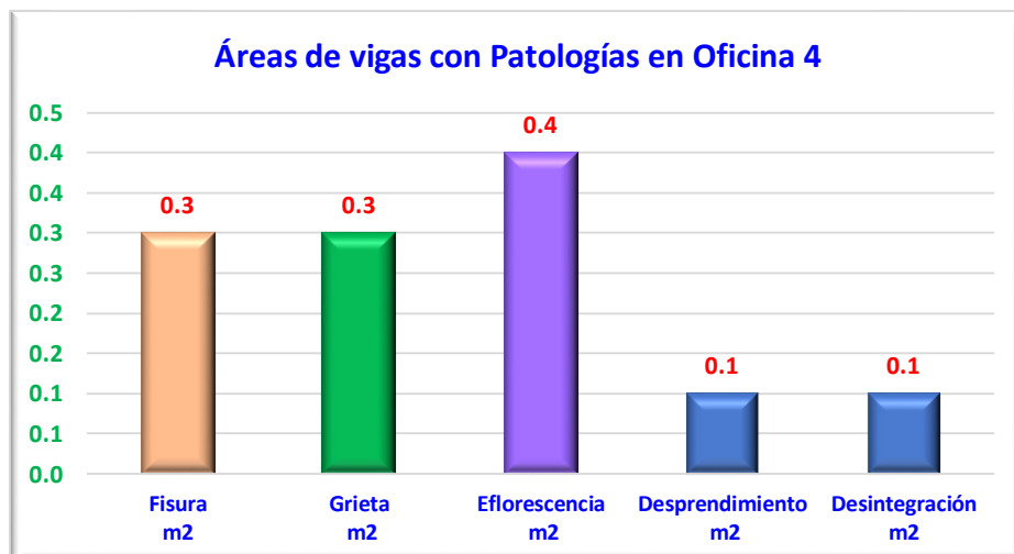
Figura 21. Área con presencia de patologías en vigas en la oficina 4
