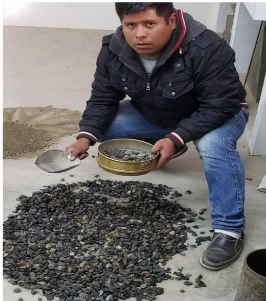
**Ensayo de Gravedad Específico y Absorción del Agregado Grueso**
