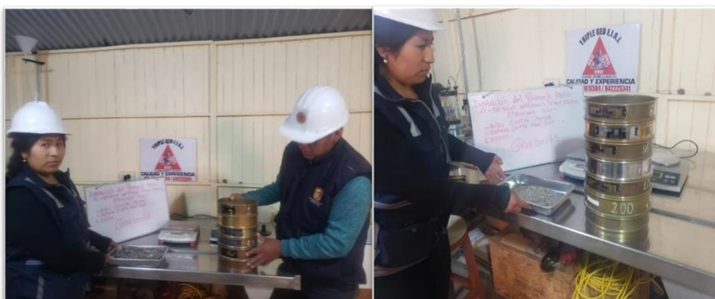
Figura 12. Granulometría de agregados los finos y grueso
