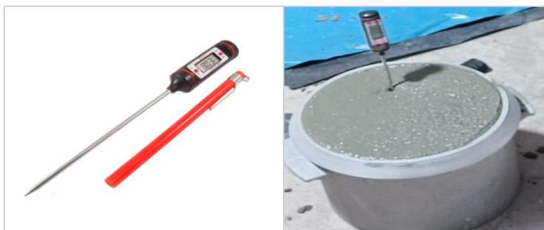
**Figura 5.** Termómetro para el concreto
