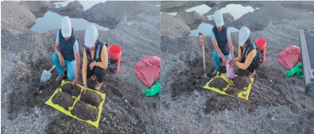
Fotografía 7, 8, 9 ensayos de contenido de humedad, granulometría de árido grueso y fino
