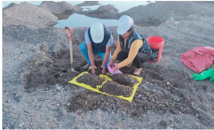
*Figura 10.* cuarteo de los agregados en la cantera.
