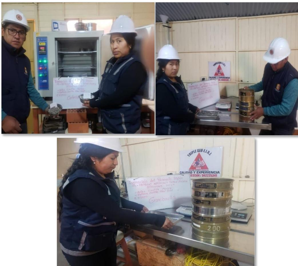
Fotografía 10 y 11, realizando el ensayo de peso unitario del agregado fino y grueso.
