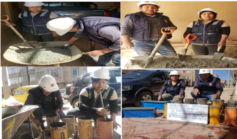
Fotografía 19,20 y 21 desencofrado de las briquetas y curado.
