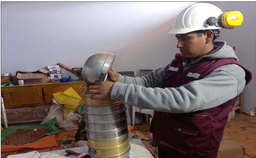
*Imagen.* Tamizado del agregado fino en el ensayo de granulometría
