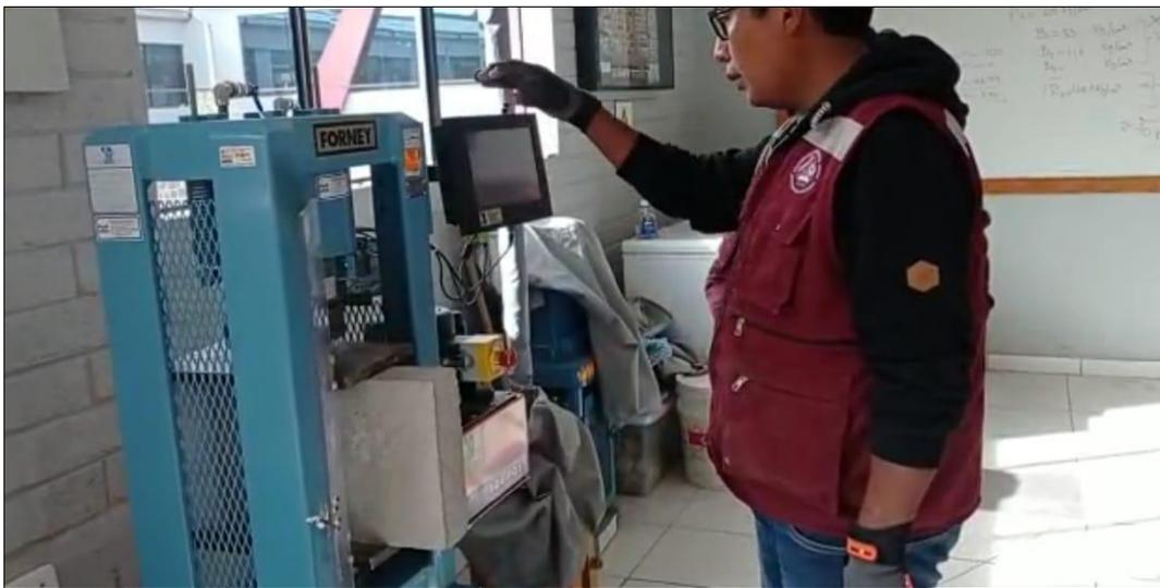
*Imagen:* Ensayo a compresión de los bloques de concreto celular
