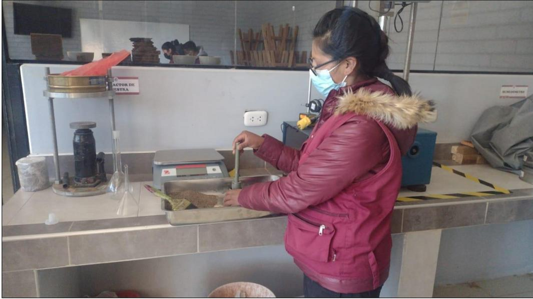
*Imagen:* Apisonado del agregado en el ensayo de absorción
