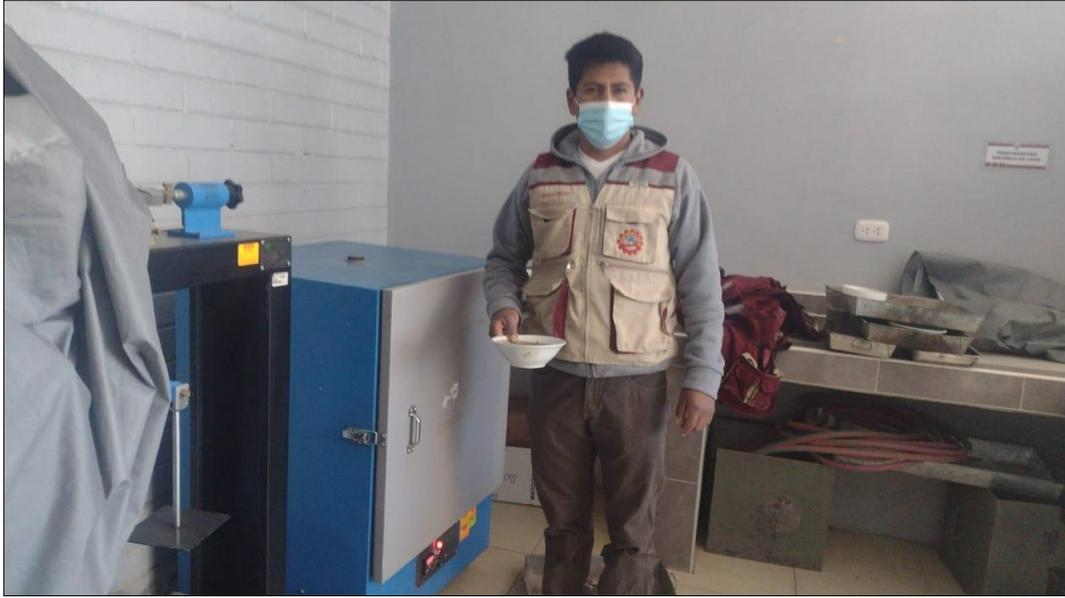
*Imagen:* Muestra secada al horno para ensayo de contenido de humedad
