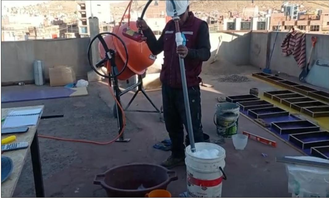
*Imagen:* Elaboración de la espuma para los bloques de concreto celular
