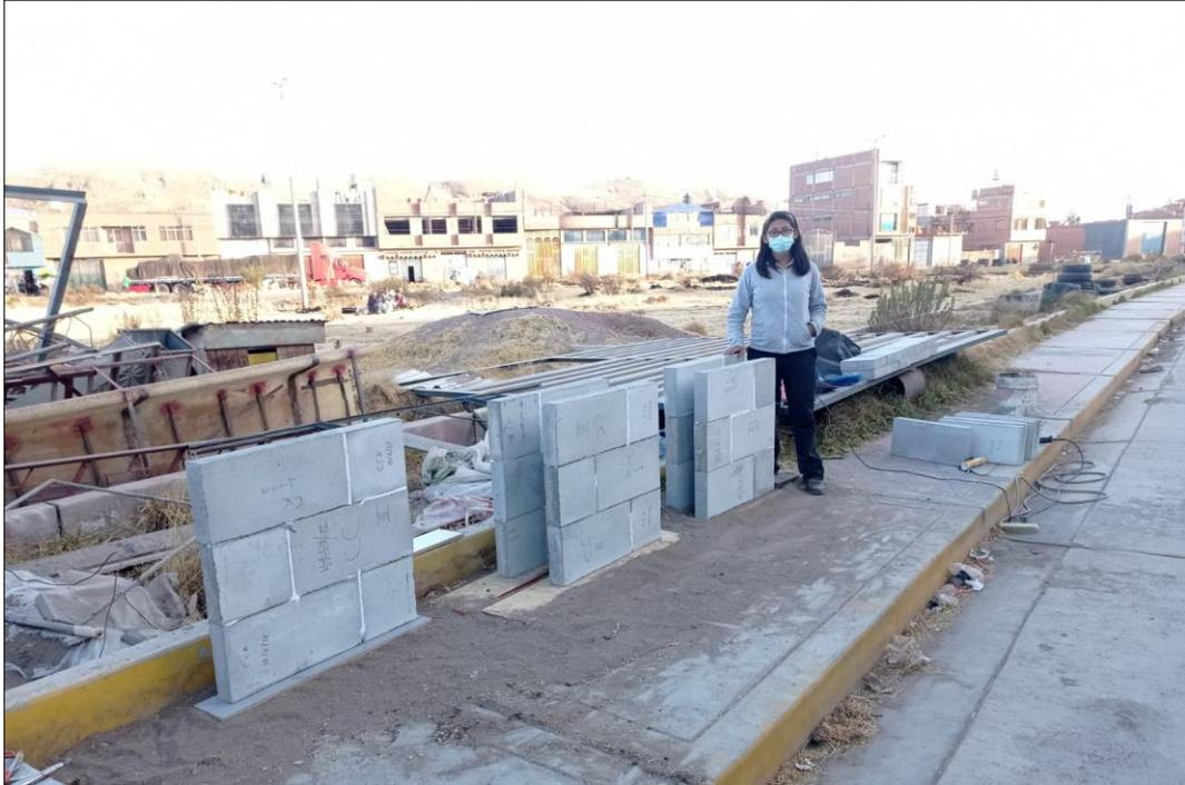
*Imagen:* Muretes de bloques CCA sin adición de fibra de vidrio y con adición de 0.60%.
