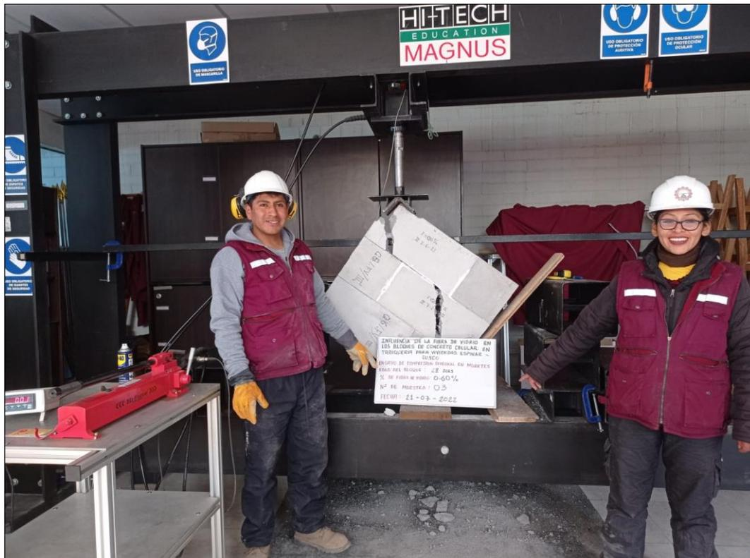
*Imagen:* Murete ensayado a compresión diagonal
