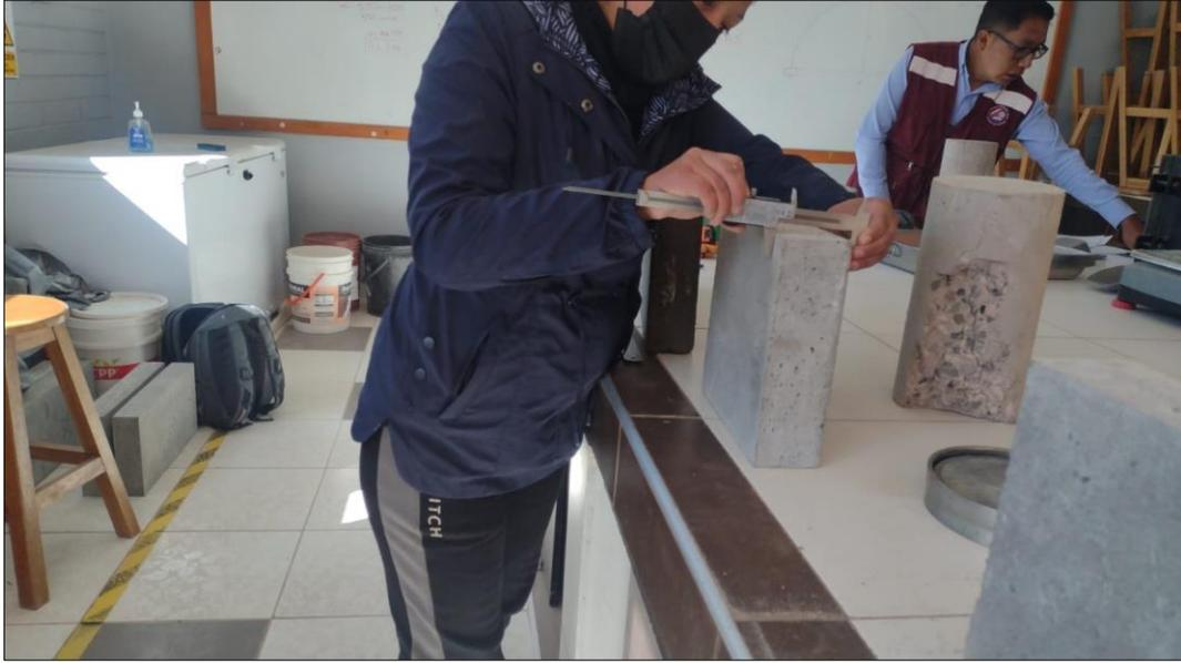
*Imagen:* Medición de dimensión usando vernier.
