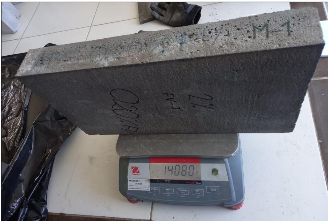
*Imagen:* Peso del bloque saturado con 0.20% de fibra de vidrio
