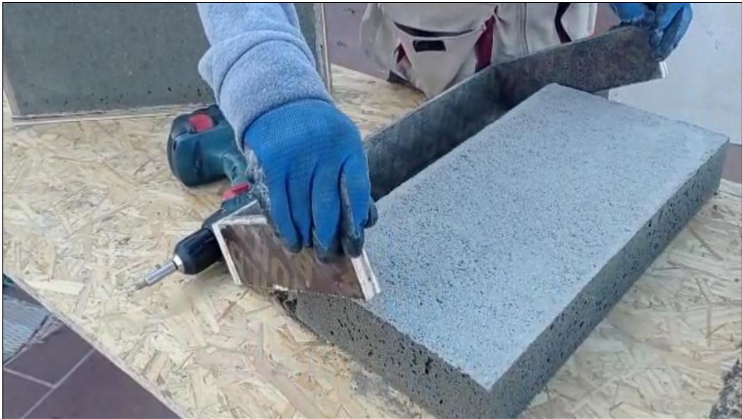
*Imagen:* Desmoldado del bloque de concreto celular
