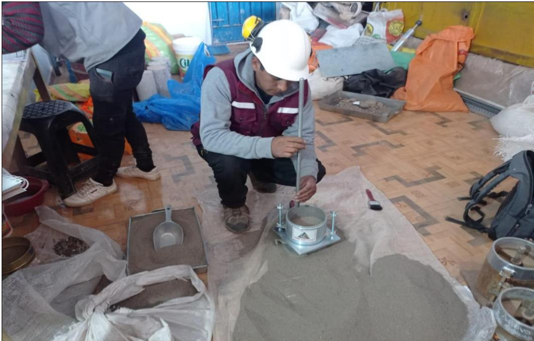
*Imagen:* Ensayo de peso unitario varillado
