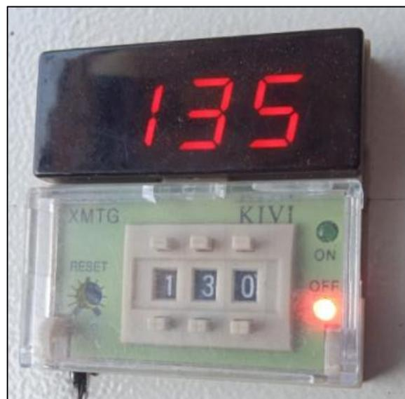
Figura 92. Temperatura programada de 130°C para secado con convección forzada y temperatura máxima por encima del valor requerido.
