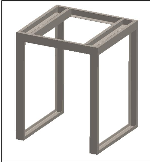
Figura 80. Estructura principal de horno secador optimizado.
