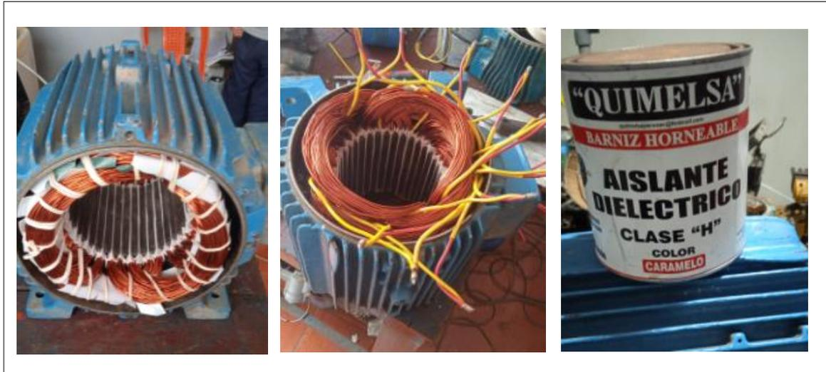
Figura 91. Mantenimiento del motor eléctrico 20 Hp.
