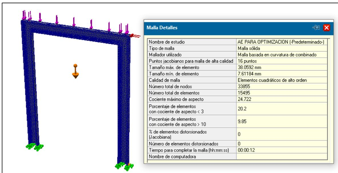
Figura 59. Mallado marco en SolidWorks.
