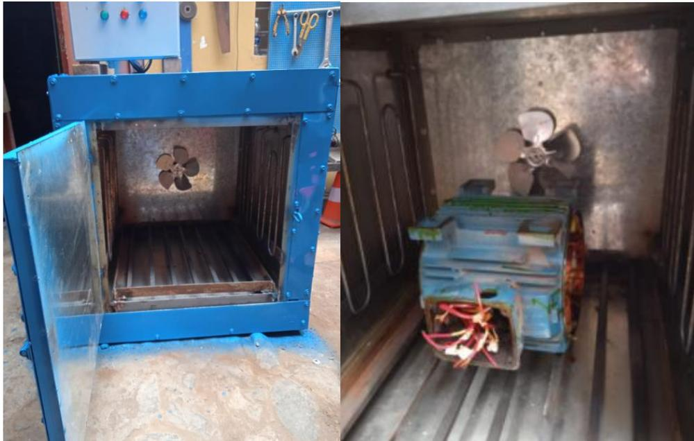
*Figura 93. Secado en horno con aire forzado.*
