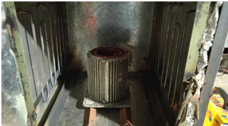
*Figura 88.* Estator en posición vertical en el interior de horno sin aire forzado.
