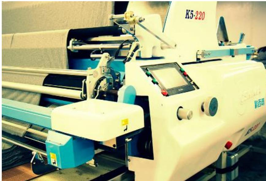
*Figura 3. Máquina de corte de tela*
