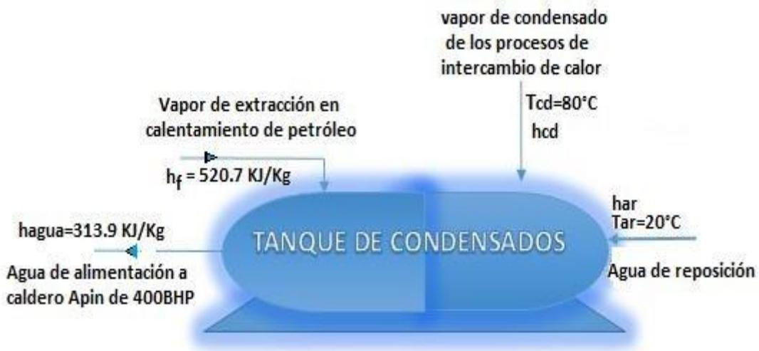
Figura 12: Variables de operación en el tanque de condensado
