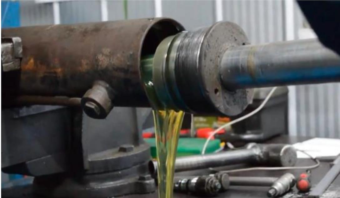
Figura 27. Mantenimiento y cambio de aceite de los pistones hidráulicos
