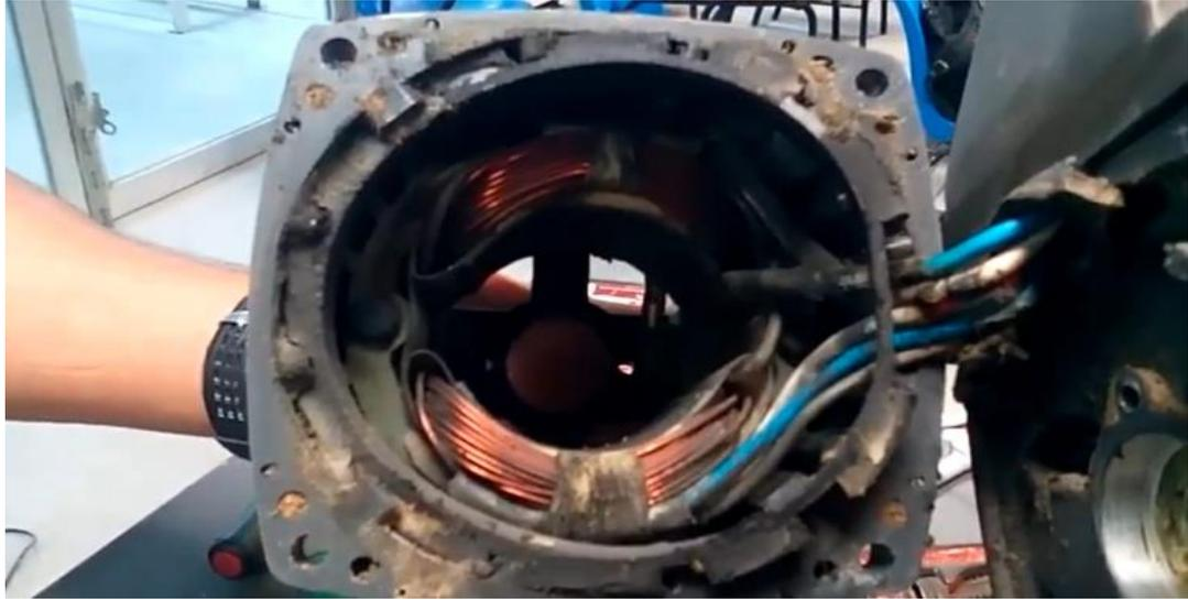
*Figura 23.* Limpieza general del embocinado de campo del motor
