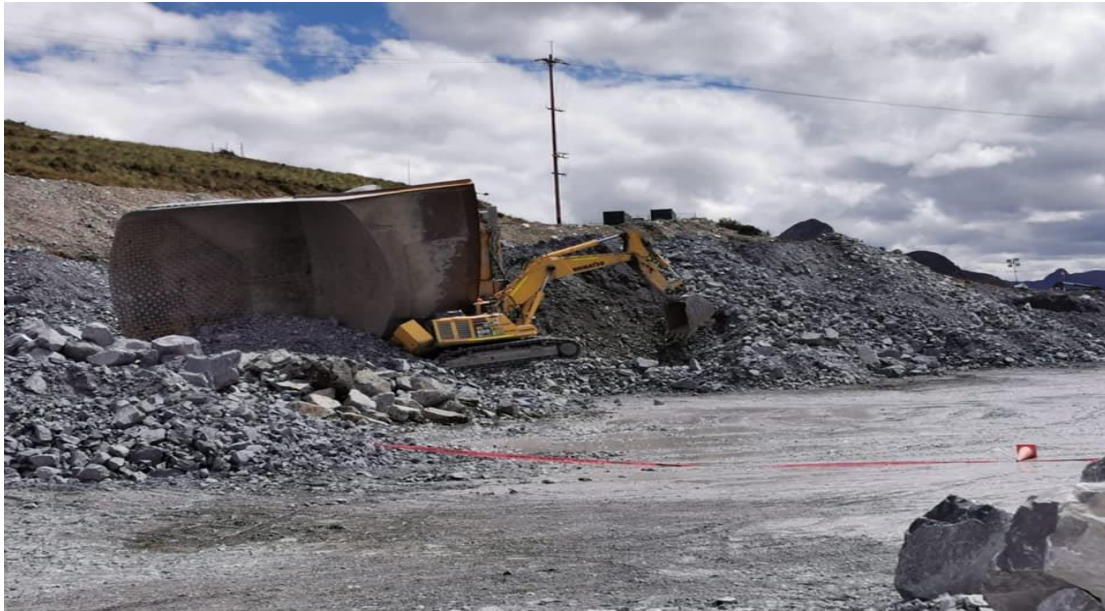
Figura 1. Accidente de camión por debilitación de plataforma
