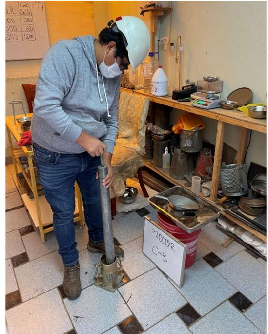
Figura 18. Ensayo de Proctor
