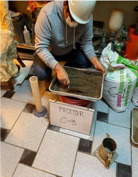
Figura 17. Ensayo de Proctor
