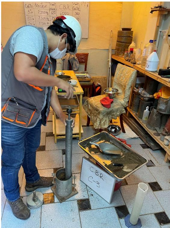
Figura 21. Ensayo de CBR
