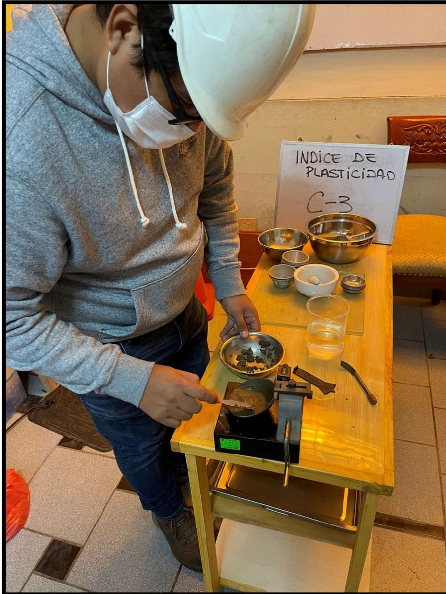
FOTO N° 02: Se está realizando el ensayo de limite líquido, mediante la cuchara de Casagrande
