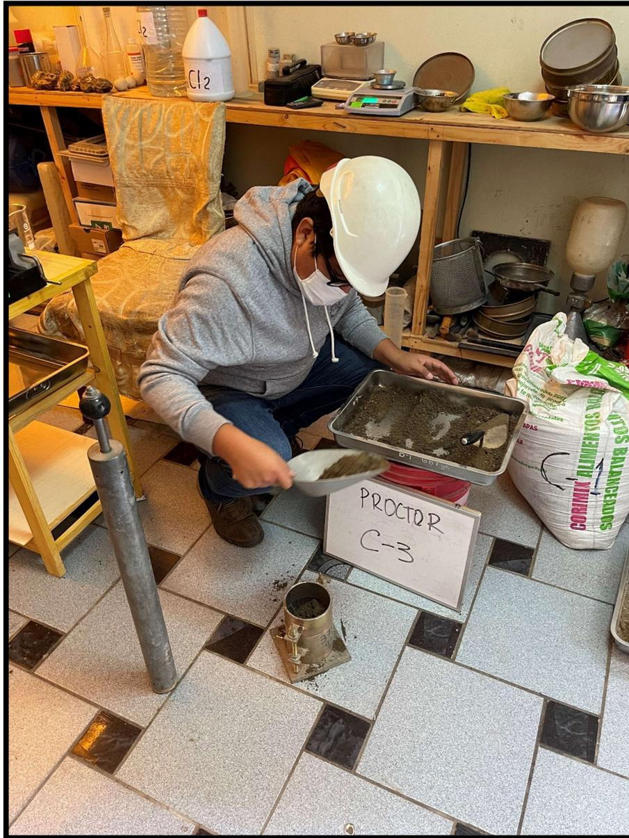
FOTO N° 03: Se está realizando el llenado del molde del Proctor estándar en combinación con el cloruro de calcio
