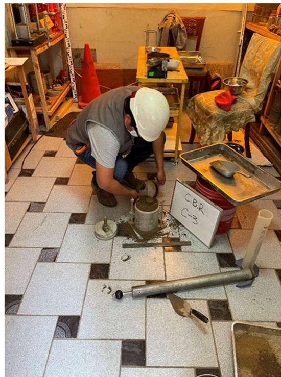
Figura 22. Ensayo de CBR
