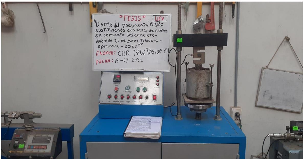
**ENSAYO DE CBR PENETRACION C - 1**
