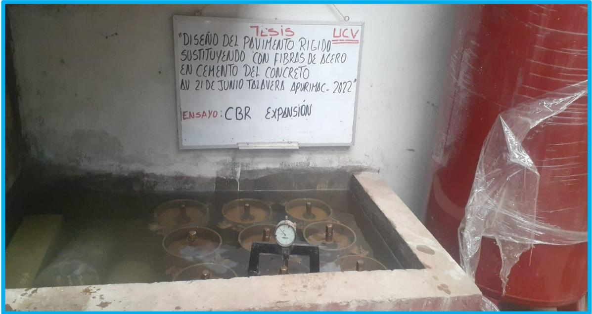
**ENSAYO DE EXPANSION DE CBR**
