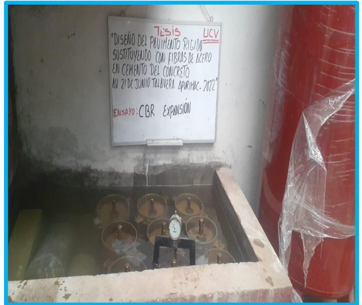
**ENSAYO DE CBR EXPANSION C – 2 y C - 3**
