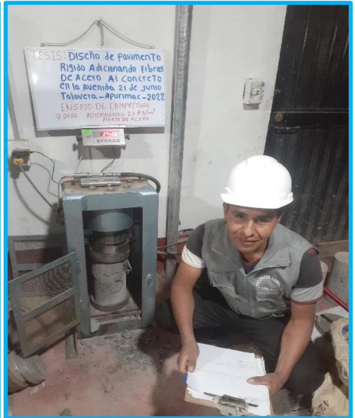
*Ensayo de las probetas con adición de fibras de acero a los 7 días de fraguado*
