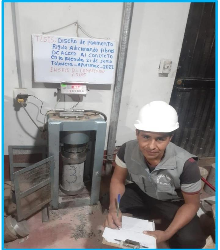
*Realizando ensayo de probetas*
