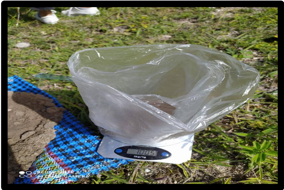
PESADO DE 1KG DE MUESTRA DE SUELO
