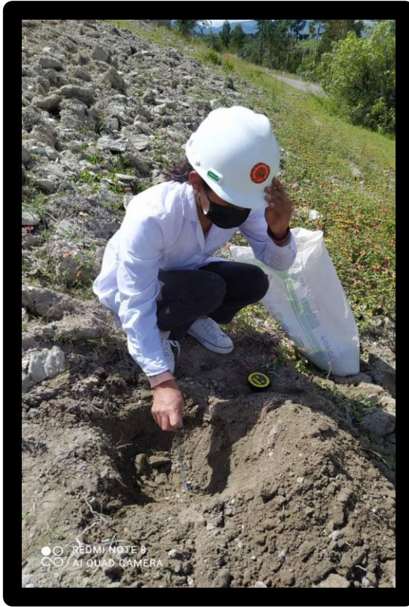
MIDIENDO LAS CALICATAS DE 30CM DE PROFUNDIDAD
