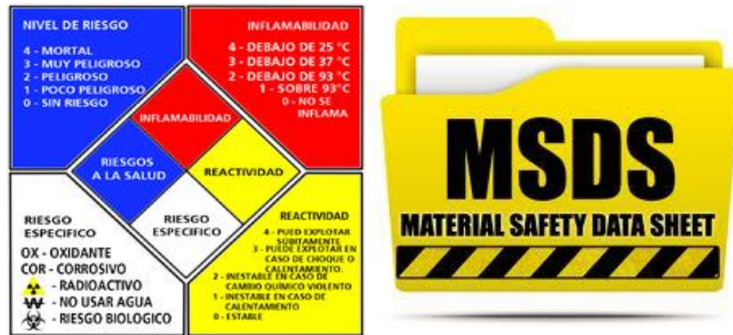
Figura 42. Hojas de datos del producto y el rombo de seguridad. Fuente: AON.
