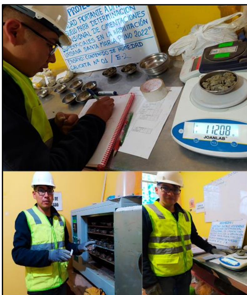
Figura 11. Ensayo de contenido de humedad
