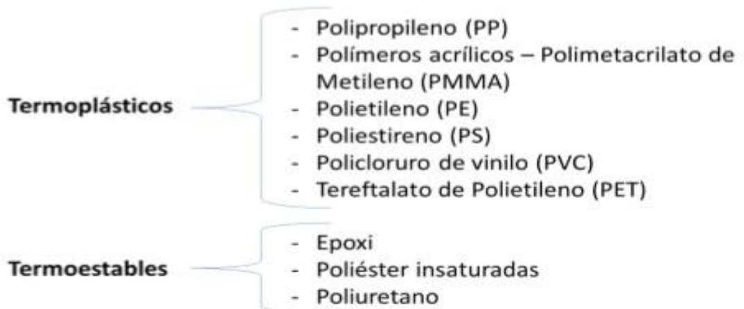
Figura 5 Polímeros utilizados en la construcción
