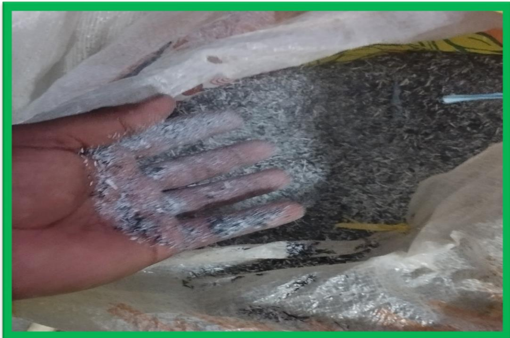
Figura 51: cenizas de cascarilla de arroz para la dosificación del 5, 10 y 15 %.
