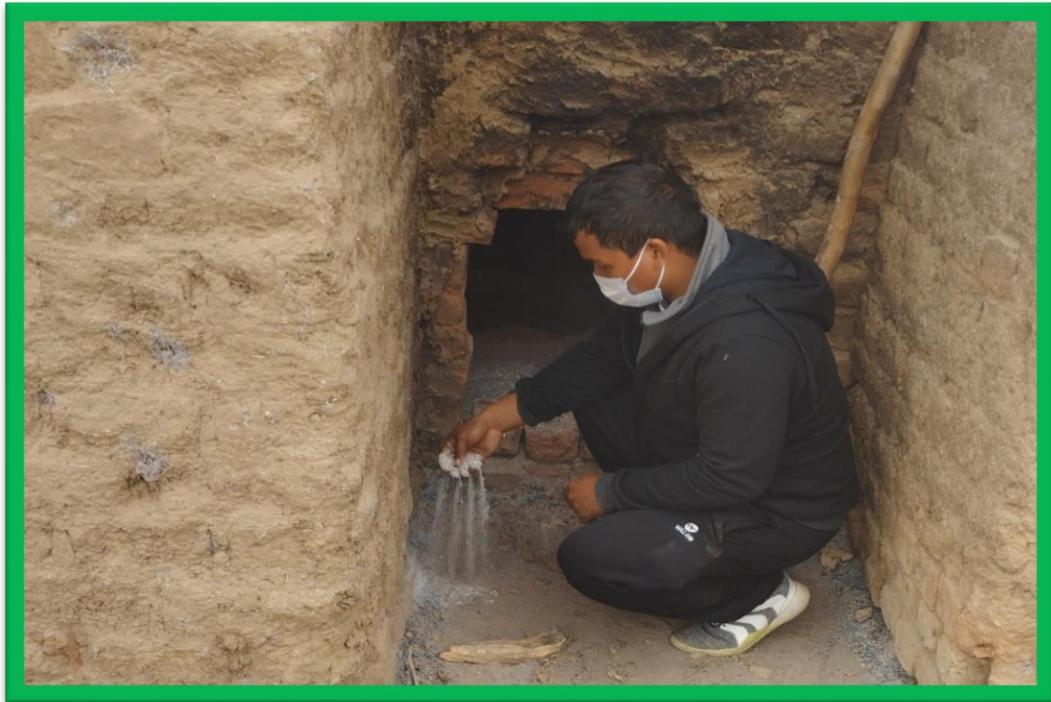
Figura 50: obtención de cenizas de cascarilla de arroz
