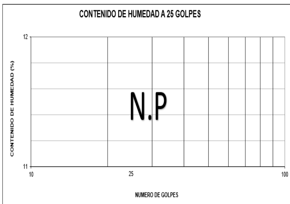
Figura 22. Límites de consistencia muestra C-1 + 15% cenizas de cascarillas de arroz del camino del sector villa primavera del distrito de Ignacio escudero Sullana – Piura
