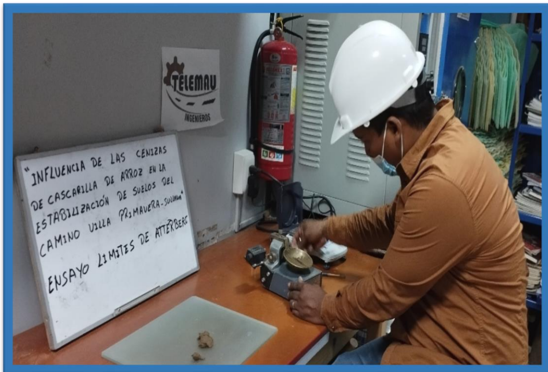
Figura 43: ensayo de límites de consistencia.
