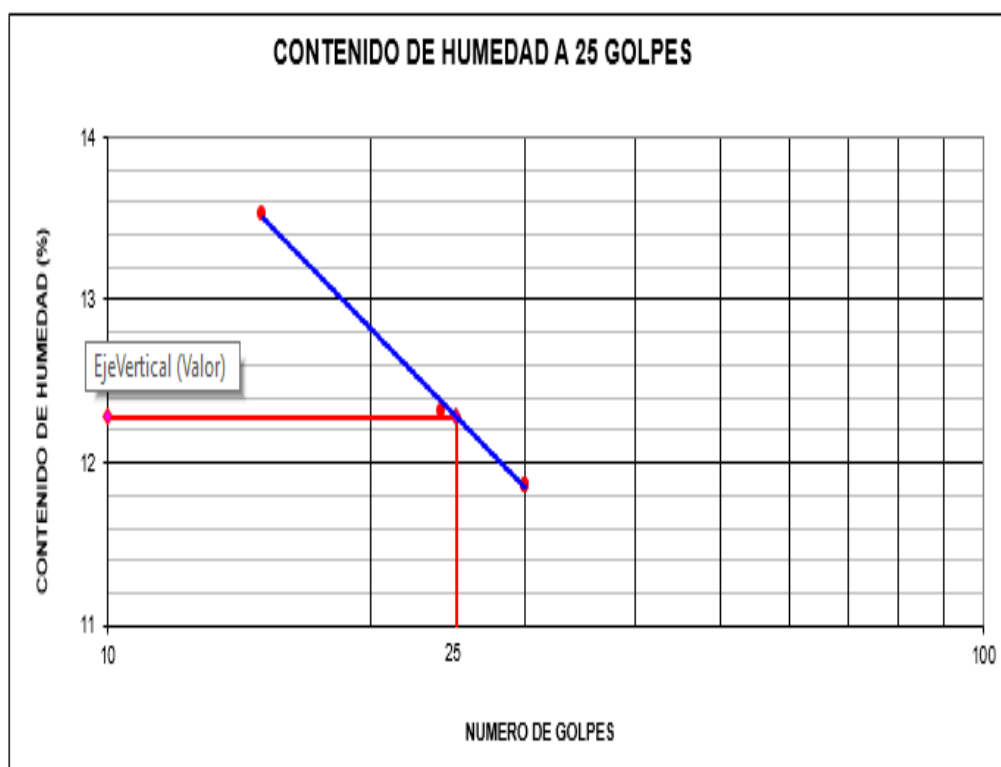
Figura 4. Límites de consistencia muestra C-1 + 5% cenizas de cascarillas de arroz del camino del sector villa primavera del distrito de Ignacio escudero Sullana – Piura
