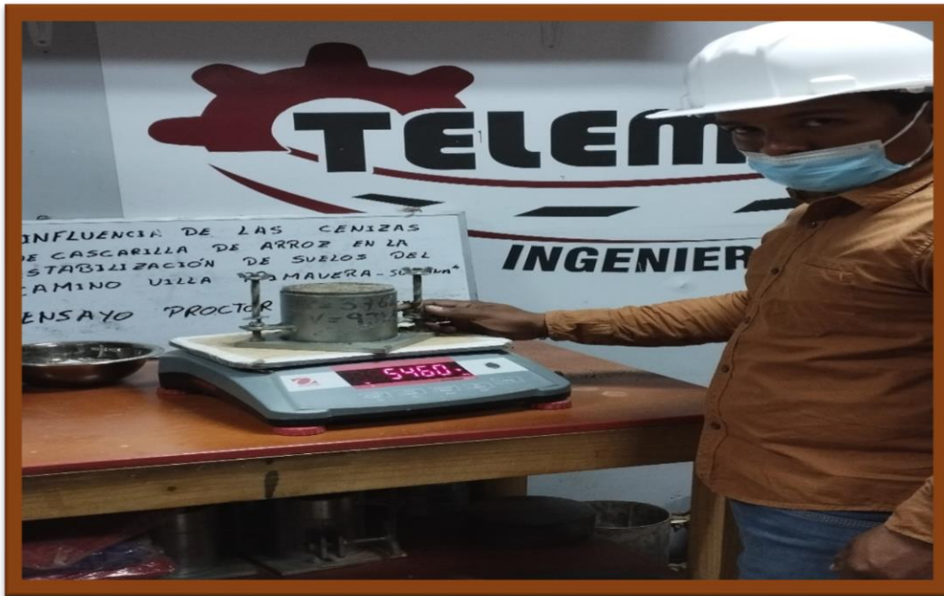
Figura 44: ensayo de proctor modificado.
