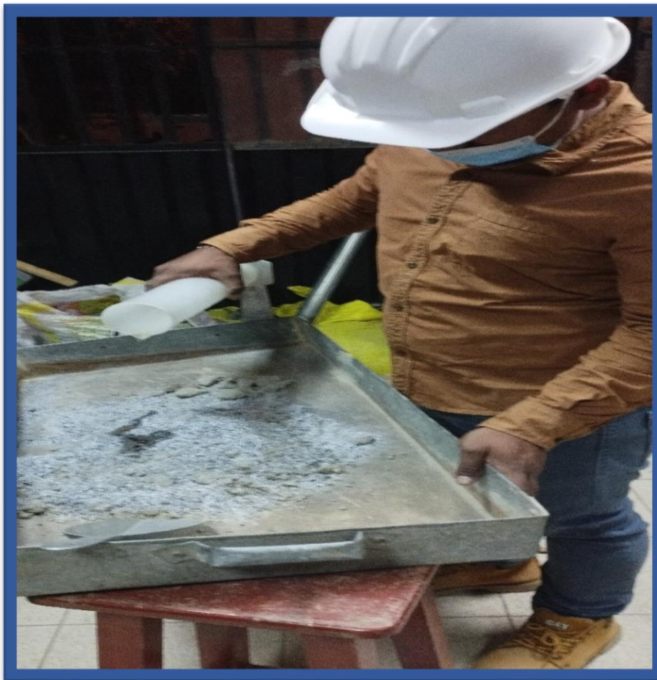
Figura 53: adición de cenizas 5, 10 y 15% en muestras de suelo natural para los respectivos ensayos de laboratorio.
