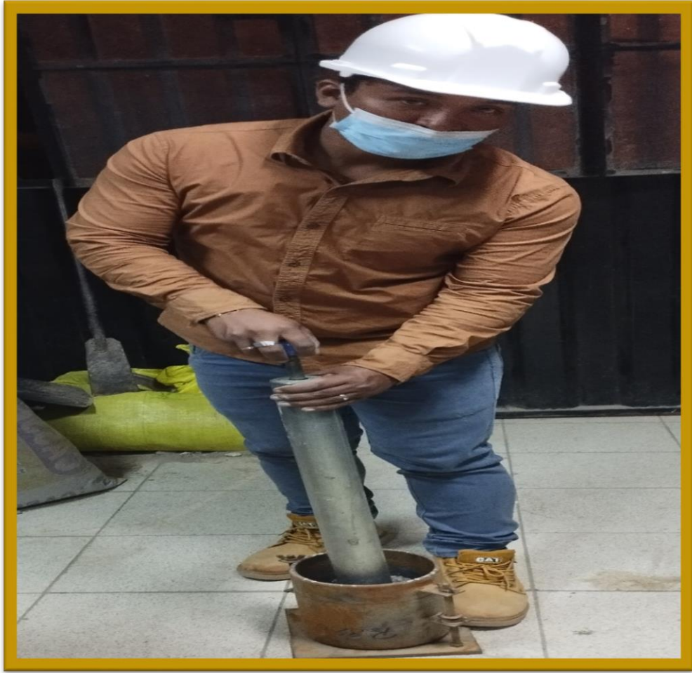
Figura 46: compactación para ensayo de CBR
