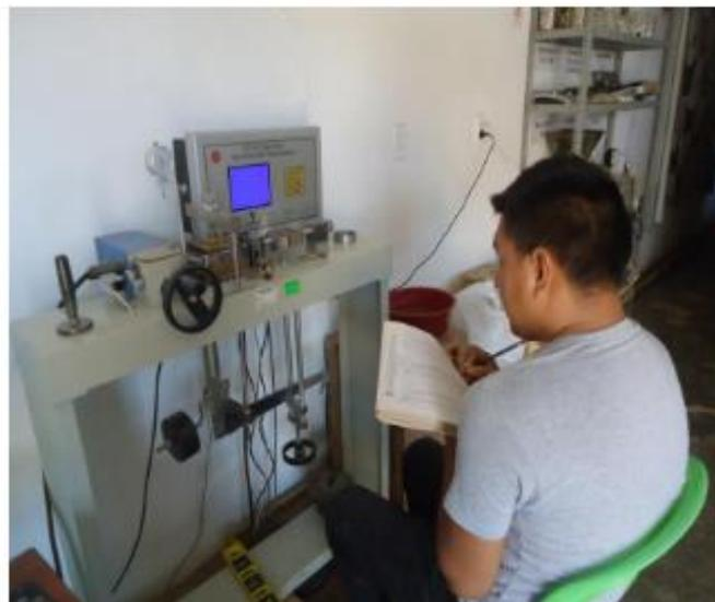
Vista fotográfica N°7. Realizando los ensayos método de corte directo en el laboratorio
