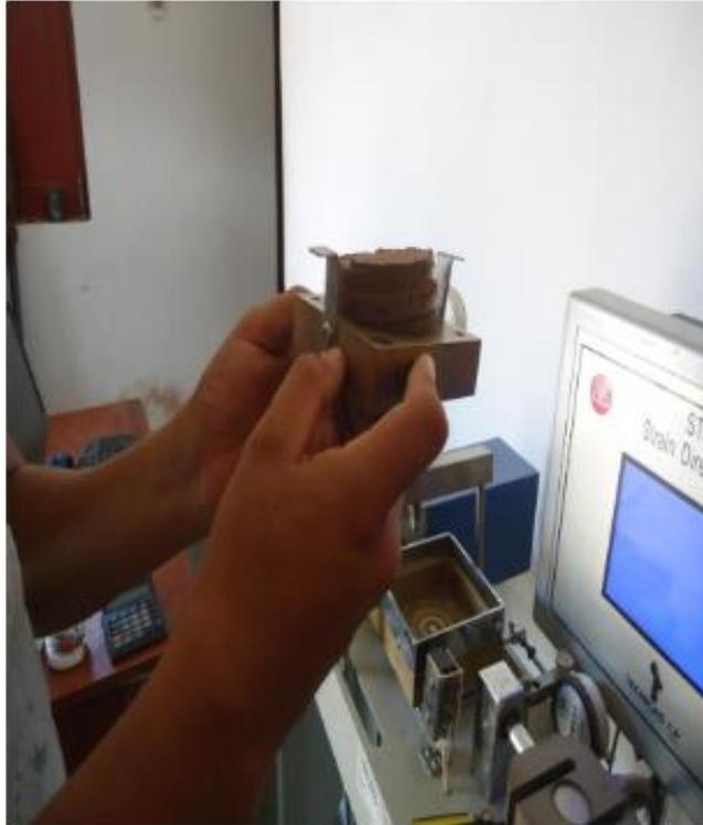
Vista fotográfica N°6. Realizando los ensayos corte directo en el laboratorio
