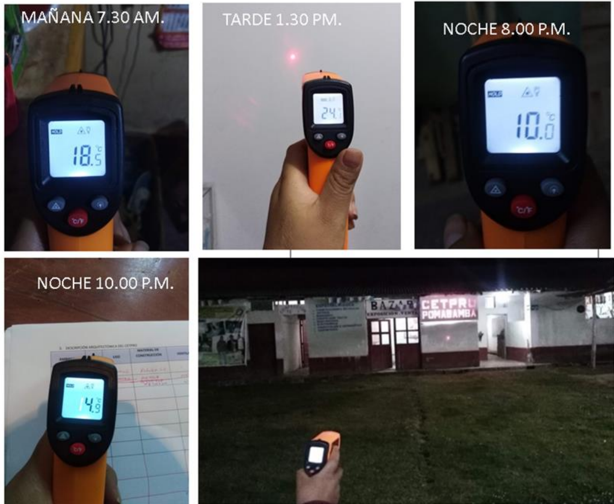
Figura 24: Medicion de temperatura del CETPRO.
