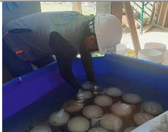
Fotografía 11. Curado de probetas
