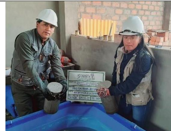
Fotografía 12. Extracción de probetas a los 7 días para su ruptura.
