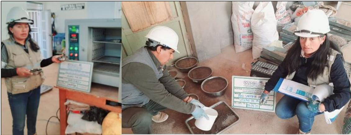
Figura 23. Colocado al horno y saturado del agregado.
