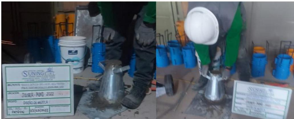
Figura 30. Ensayo de slump.
