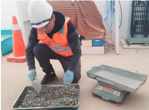
Fotografía 7. Ensayo absorción
