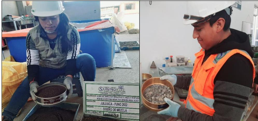
Figura 19. Granulometría de los agregados
