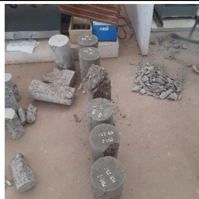
Fotografía 18. Probetas comedias a ruptura
