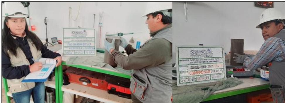
Figura 35. Medición y pesado de las probetas.
