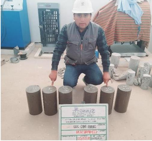
Fotografía 13. Ensayo ruptura de probeta
