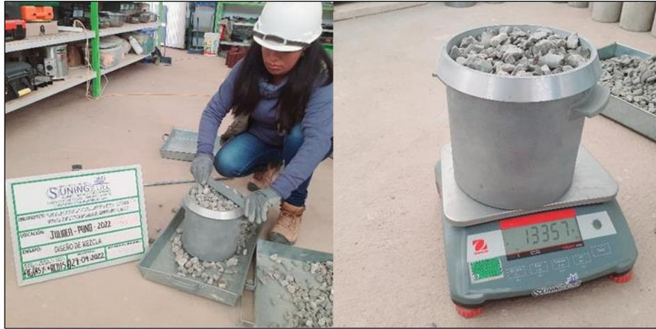
Figura 21. Enrasado y pesado de los agregados.
