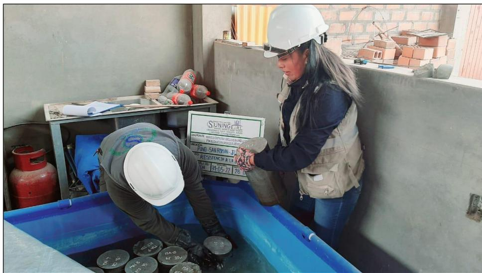
Figura 33. Curado de testigos de concreto.
