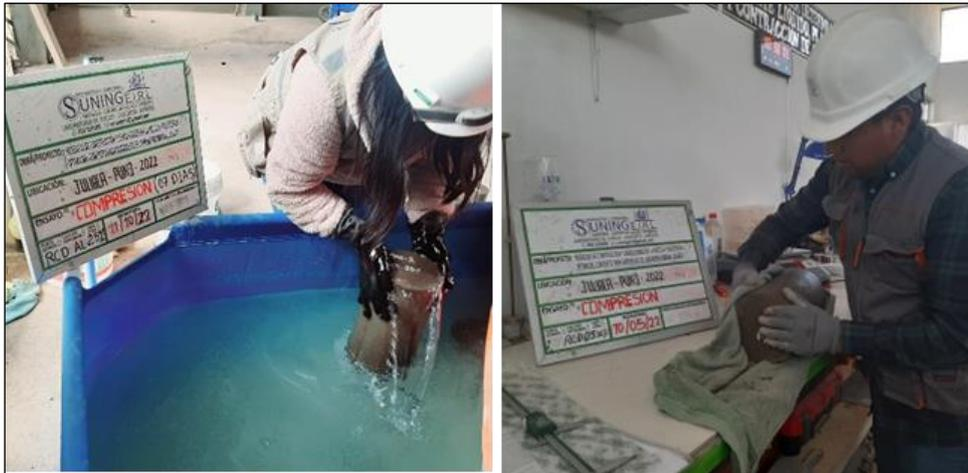
Figura 34. Extracción de testigo de la posa y secado de las probetas.
