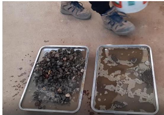
Fotografía 6. Saturado de los agregados
