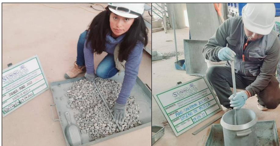
Figura 20. Método del cuarteo y compactación del agregado.
