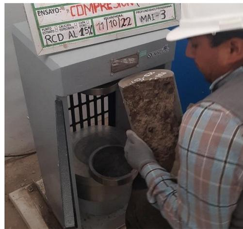
Fotografía 16. Ruptura de probeta
