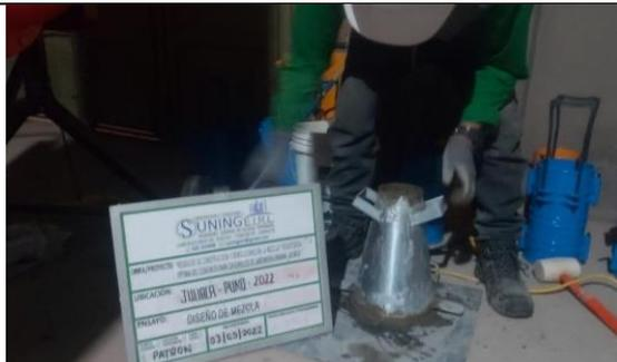
Fotografía 9. Ensayo de slump
