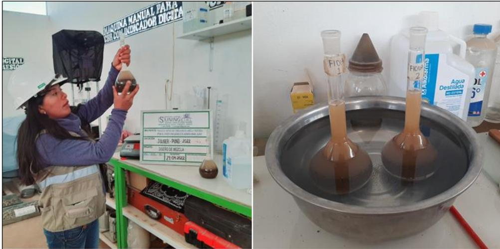
Figura 25. Ensayo de picnómetro.
