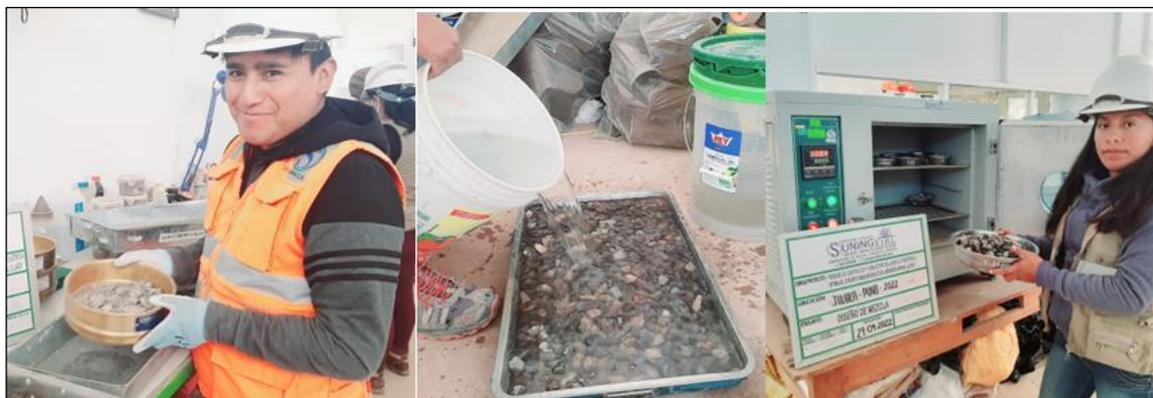
Figura 26. Ensayo de gravedad específica.
