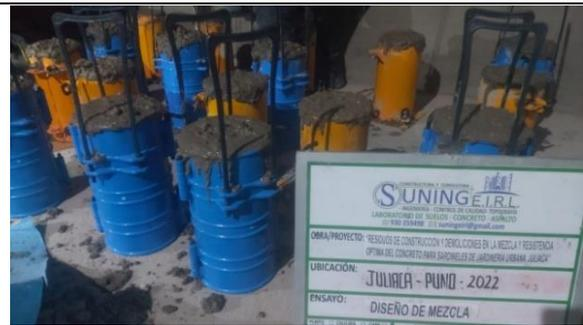
Fotografía 10. Vaciado de briquetas
