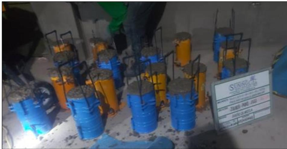
Figura 32. Elaboración de testigos de concreto.
