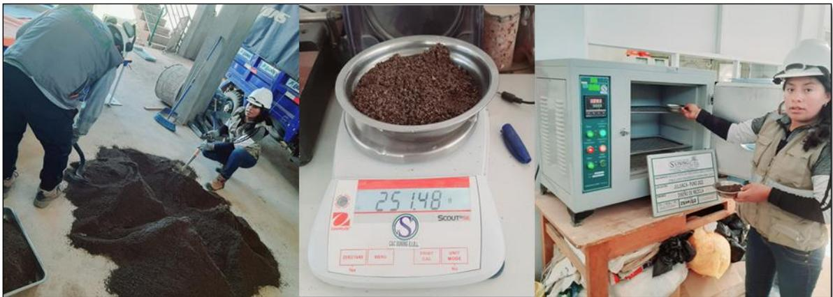
Figura 18. Granulometría de los agregados
