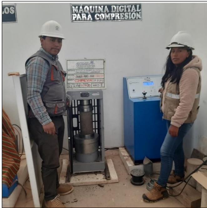
Figura 36. Resistencia a la compresión de las probetas.
