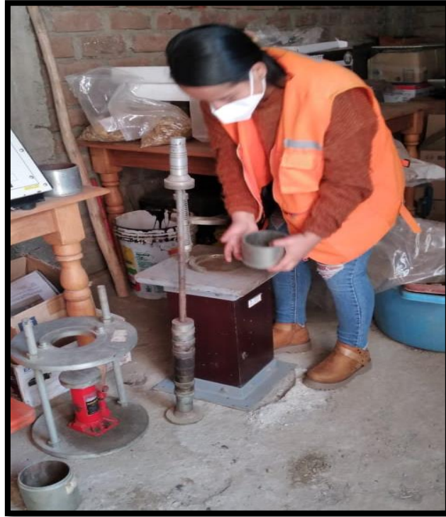
Figura 29. Compactación de mezcla asfáltica
