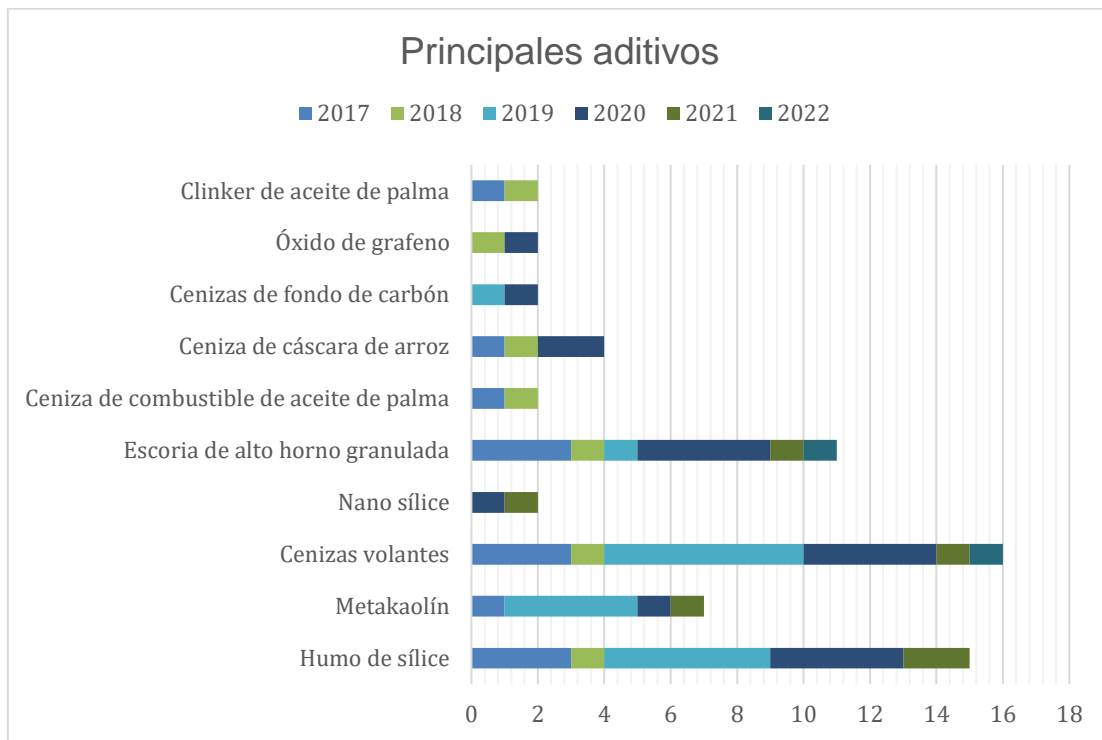
Figura 3. Principales aditivos utilizados en la elaboración de concreto con agregado reciclado.
