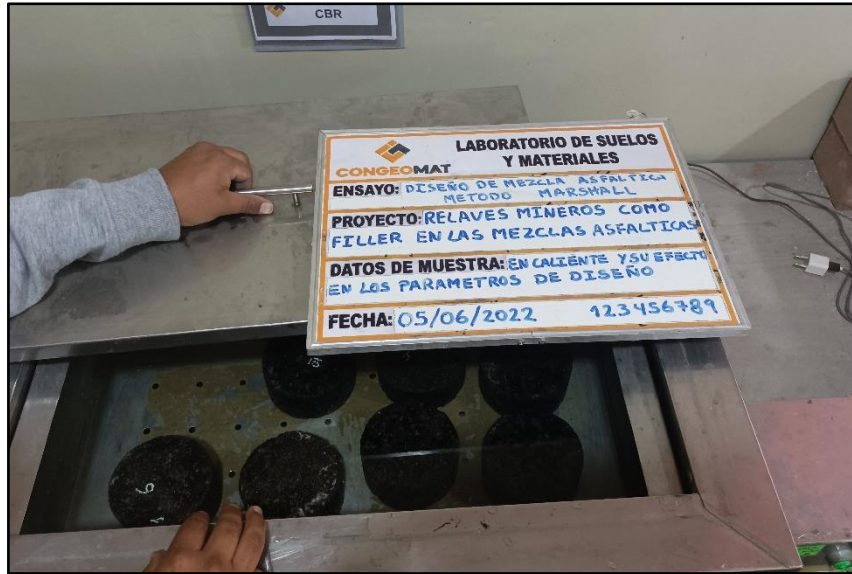
Figura 34: Inmersión de los especímenes en agua.
