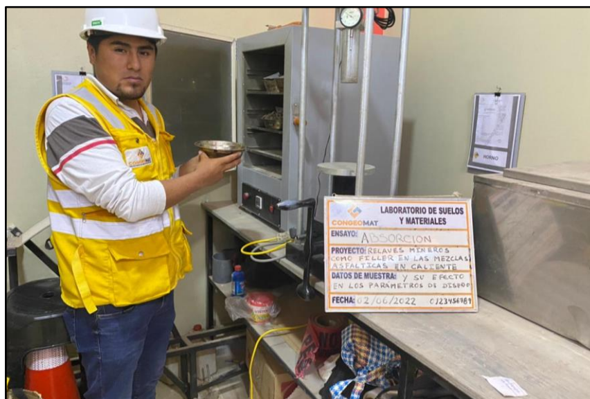
Figura 26: Ensayo de Absorción de los agregados gruesos.
