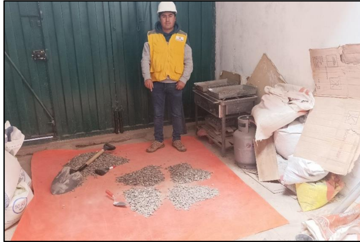
Figura 20: Cuarteo de los agregados.
