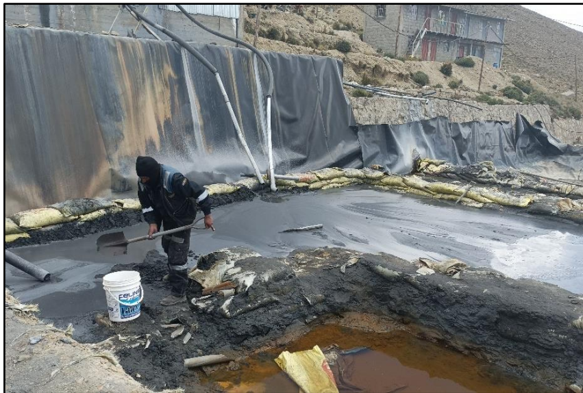
Figura 18: Extracción de relave minero.
