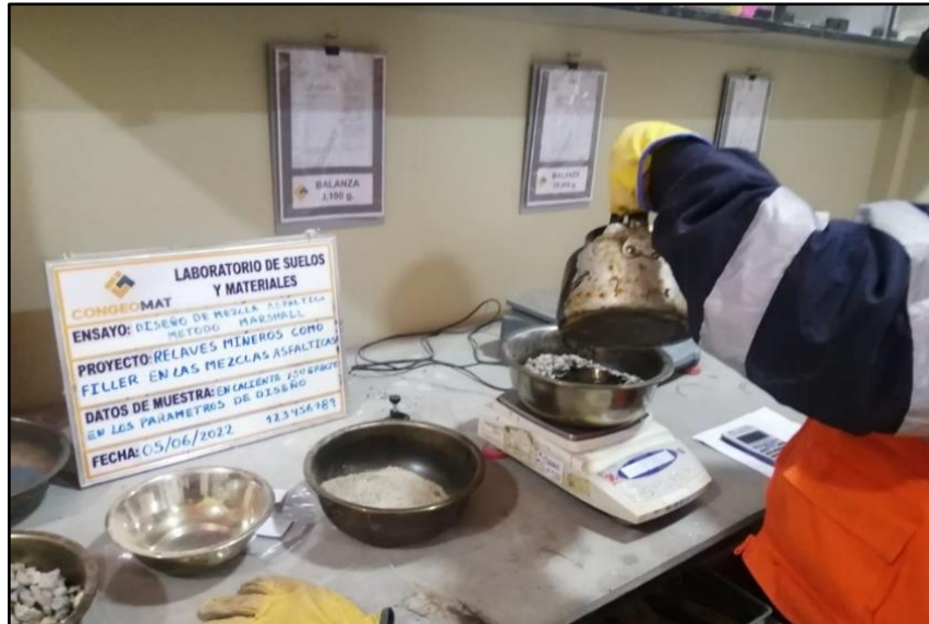
Figura 30: Mezcla de los agregados, filler y cemento asfáltico.
