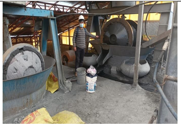
Figura 4: Vista de molienda de roca con la maquina trapiche.
