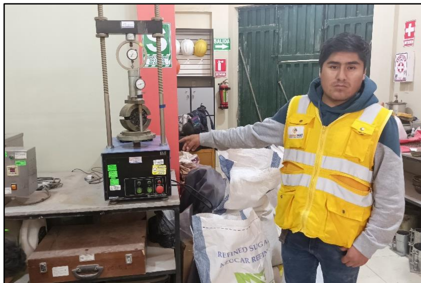
Figura 35: Medicion de la Estabilidad y Flujo Marshall.
