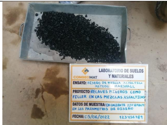
Figura 9: Mezcla Asfáltica en Caliente.
