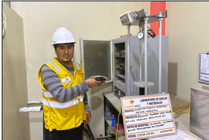
Figura 28: Calentamiento de cemento asfáltico.
