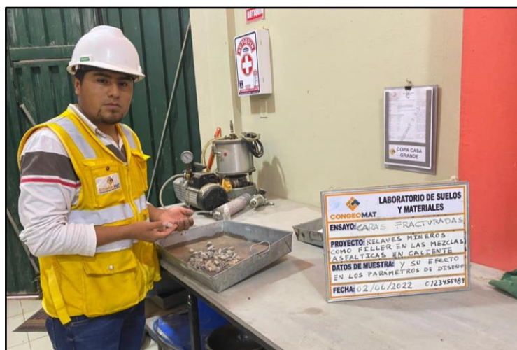
Figura 24: Ensayo de Partículas Chatas y Caras Fracturadas.
