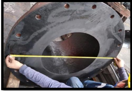
bridas de descarga y alimentación
