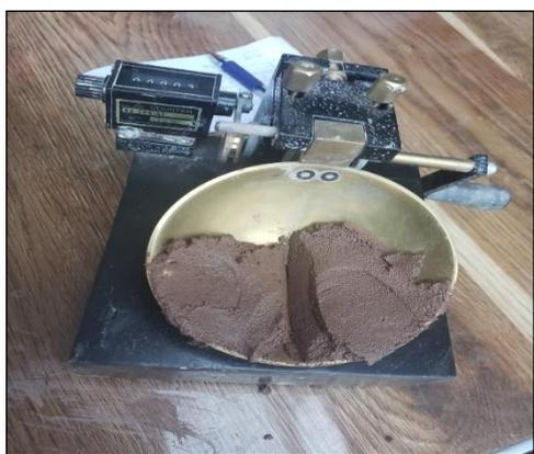
Figura 20. Ensayo de Limite Líquido
