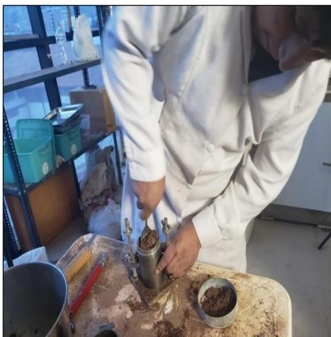
Figura 33. Ensayo de Compactación del Proctor Modificado.
