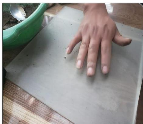
Figura 21. Ensayo del Limite Plástico
