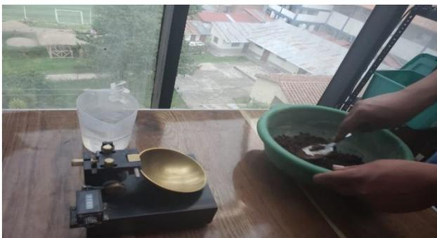
Fotografía 7: Ensayo de Casagrande
