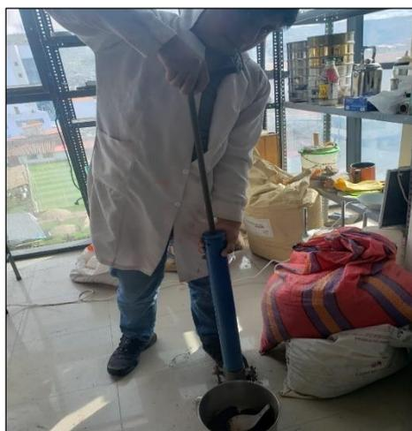
Figura 32. Compactación para el ensayo de Proctor Modificado.
