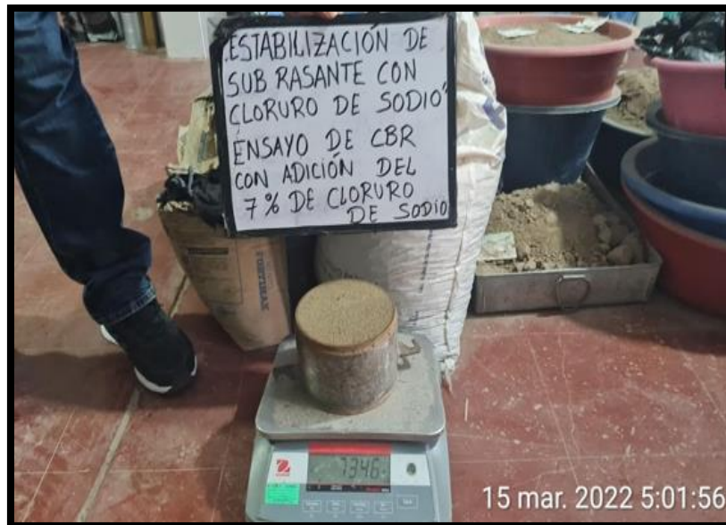
Figura 16. Peso de la muestra compactada de 56, 25 y 12 golpes con adición de cloruro de sodio
