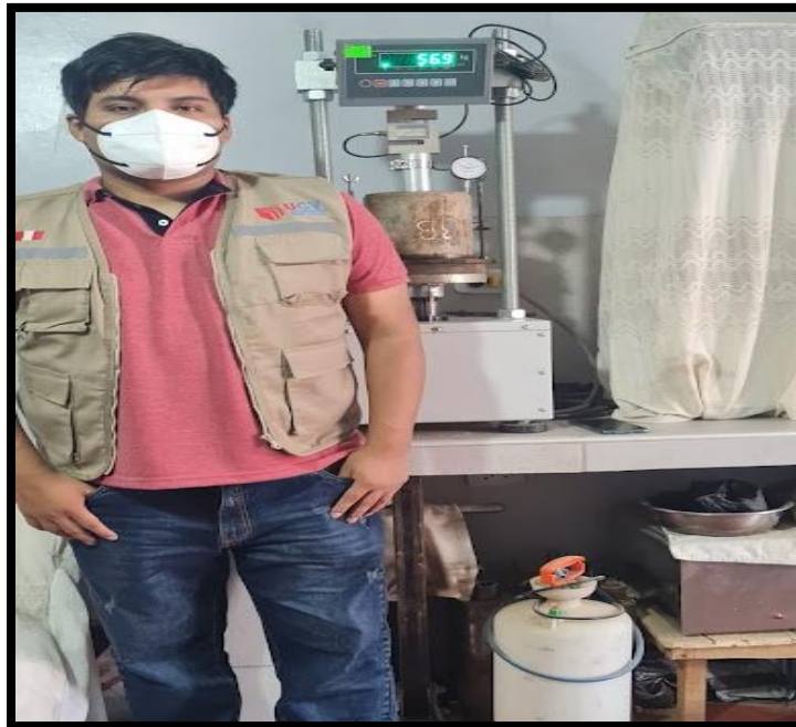
Figura 20. Ensayo de la prensa CBR con adición de cloruro de sodio
