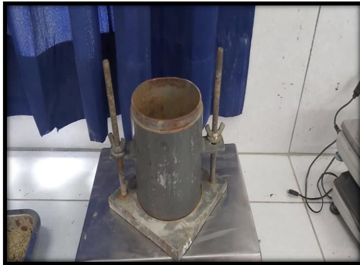
Figura 8. Ensayo de Proctor Modificado
