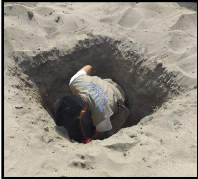
Figura 3. Excavación de la calicata
