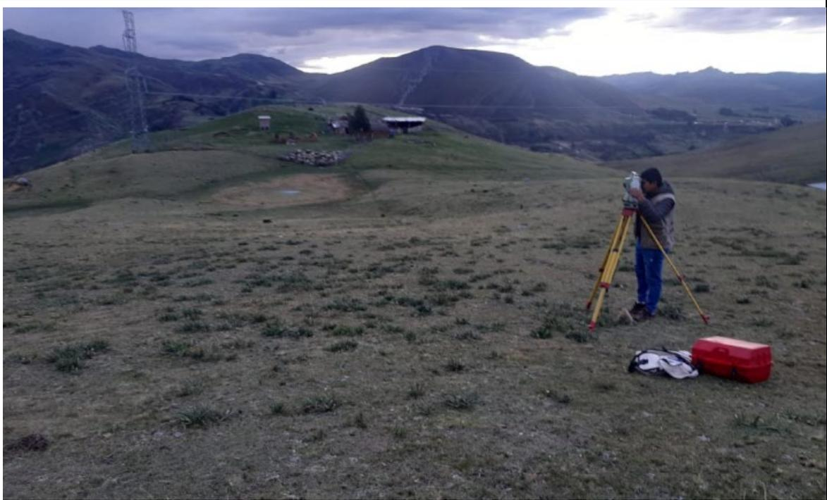
Realizando el levantamiento topográfico en el tramo final y verificando.
