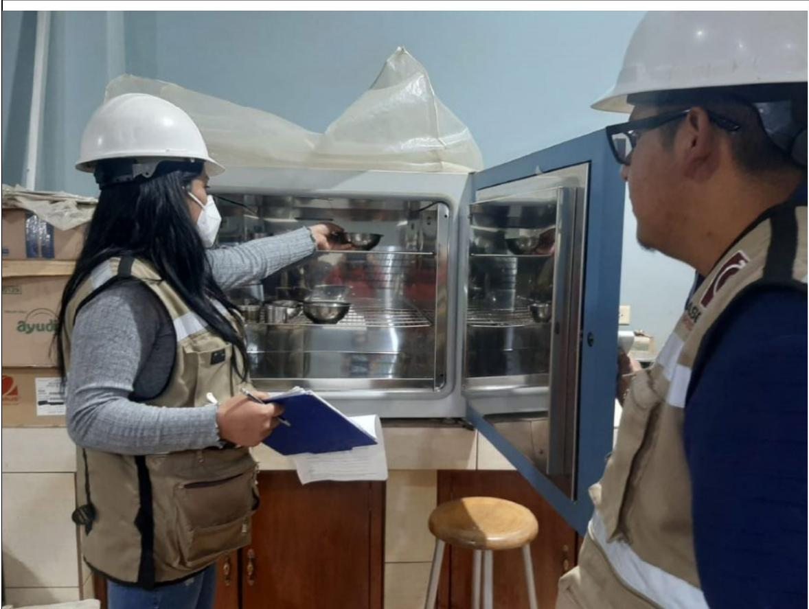
Colocación de la muestra al horno.
