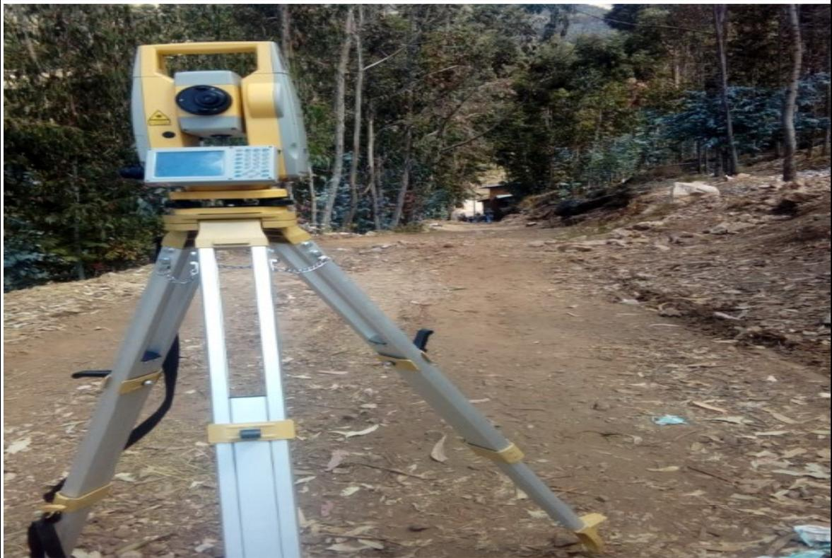
Realizando el levantamiento topográfico en el primer tramo KM 0+000-1+000
