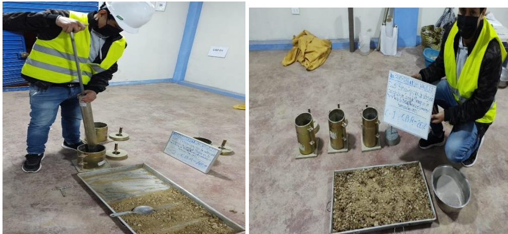
Figura 18: CBR de suelo de C-1 y C-2 al 95% y 100% y con adición de cenizas de madera al 18%, 20%, 22% y 18%
