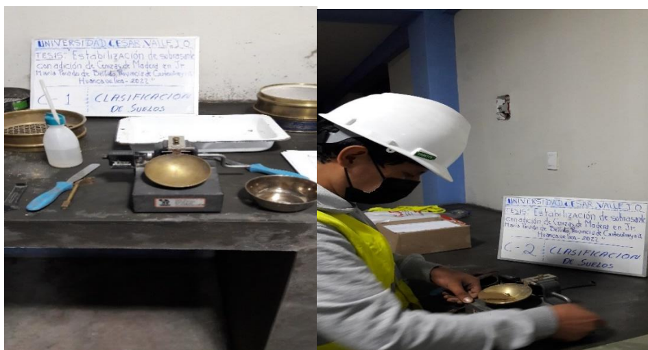
Figura 12: Determinación del límite líquido de un suelo por el método de Casagrande
