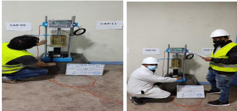
Figura 21: CBR de C-1 y C-2 con adición de cenizas de madera al 24% y 22%
