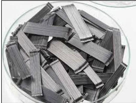
*Figura 4.* Fibra metálica para shotcrete.
