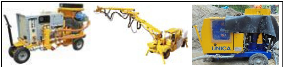
*Figura 7.* Diversas máquinas para aplicación de shotcrete
