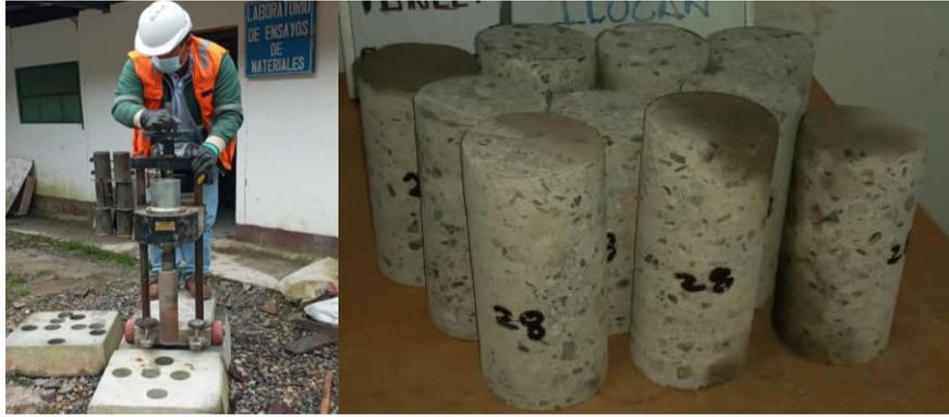
*Figura 5.* Extracción de núcleos diamantinos para ensayos de resistencia a la compresión del shotcrete.
