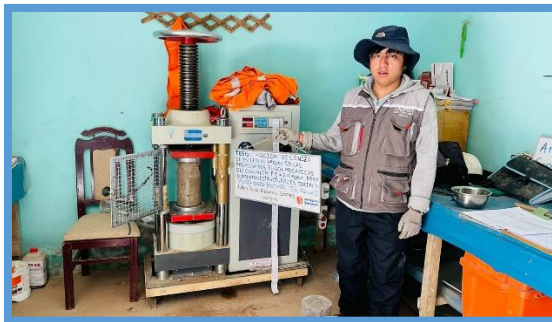
Figura 43. Rotura adición 1% 7 días
