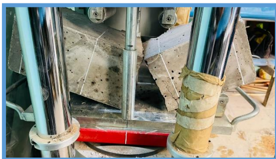
Figura 55. Rotura viga 2% de 28 días
