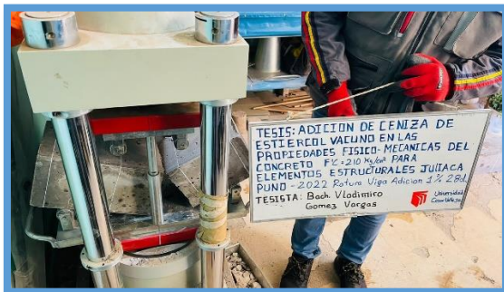
Figura 53. Rotura viga 28 días 1% adición
