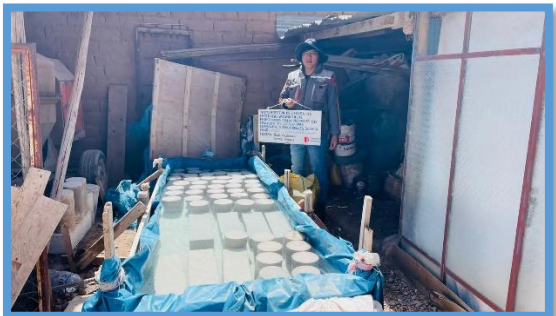
Figura 38. Curado de vigas
