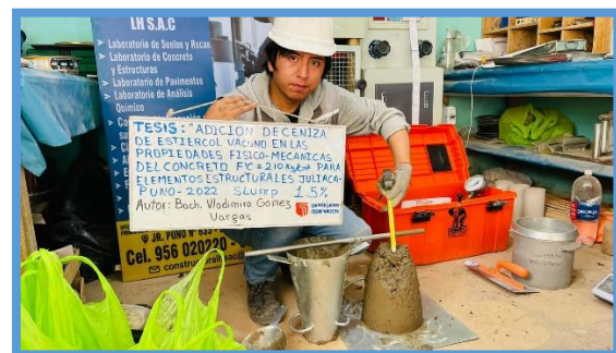
Figura 18. Medición del asentamiento slump
