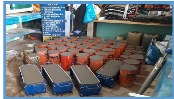
Figura 36. Moldeo de vigas
