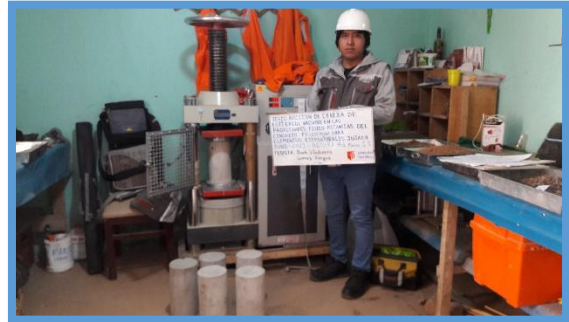
Figura 46. Rotura 1% adición 14 días
