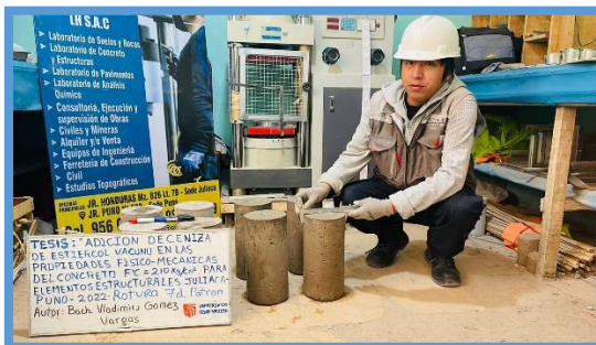
Figura 11. Medición de testigos cilíndricos
