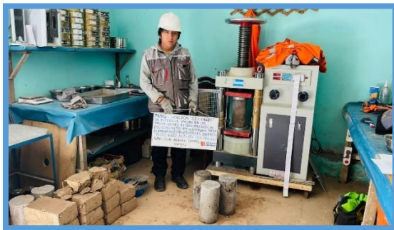
Figura 45. Rotura 2% adición 7 días
