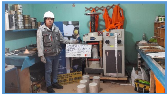
Figura 48. Rotura adición 2% 14 días
