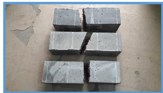
Figura 56. Resultado de roturas en vigas
