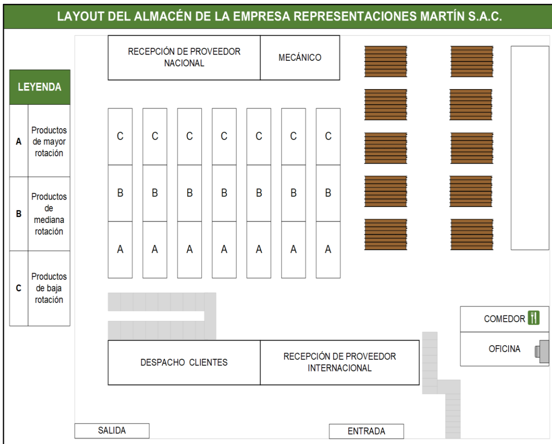
Figura 20. Nuevo Layout de la distribución del almacén
