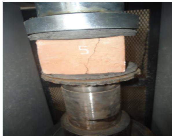
Fotografía N° 16: Falla del ladrillo luego de la carga .
