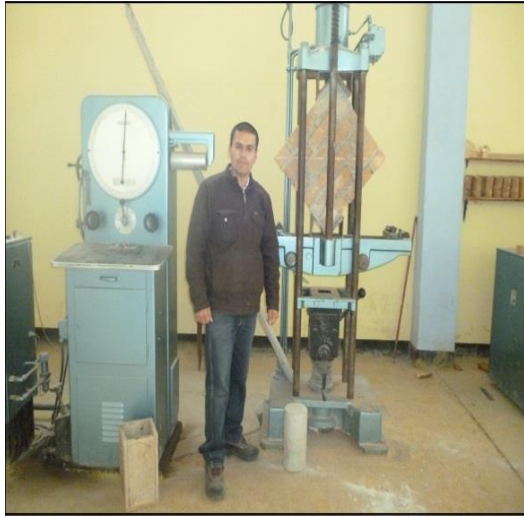
Figura 17: Murete colocado en la máquina de ensayo en el laboratorio de la UNC.
