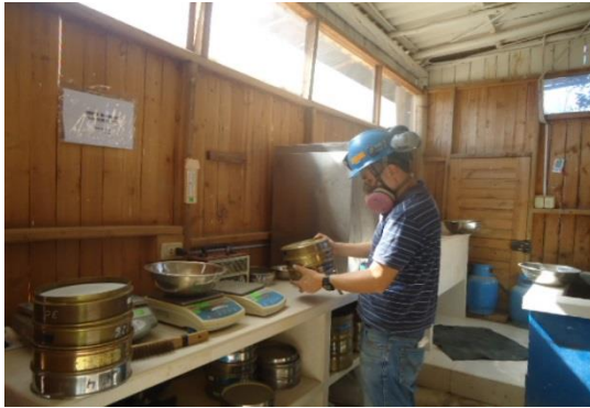
Foto N° 13: Tamizado de la arena gruesa para el análisis granulométrico
