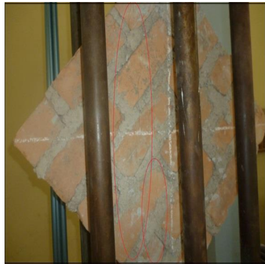
Figura 18: Falla del murete posterior a la carga.
