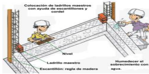
Figura N° 8: Uso de la regla escantillón
