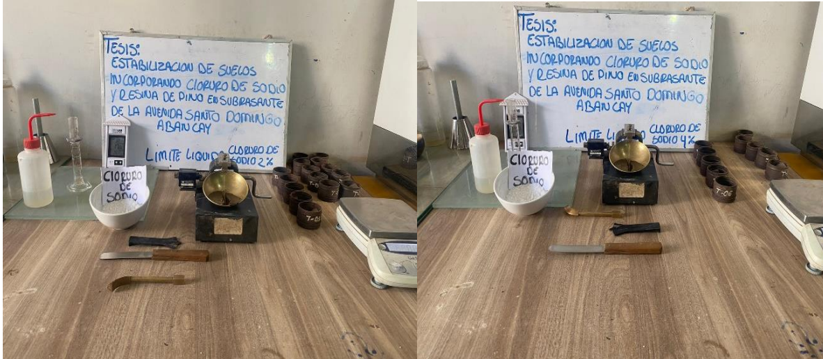
En las imágenes se presentan el desarrollo del Limite Liquido utilizando la ASTM D-423 de la C-01 y C-02 con incorporación de cloruro de sodio al 2% y 4% en el Laboratorio de Suelos denominada GRUPO CORPORATIVO OBREGON.
