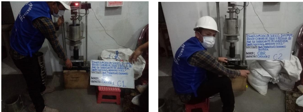
En las imágenes se presentan el desarrollo de California Bearing Ratio – CBR utilizando la norma ASTM D-1883 de las C-01 y C-02 en el Laboratorio de Suelos denominada GRUPO CORPORATIVO OBREGON.
