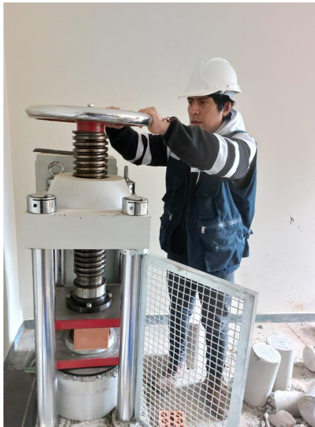
Foto 6 Resistencia a la compresión de las unidades de albañilería
