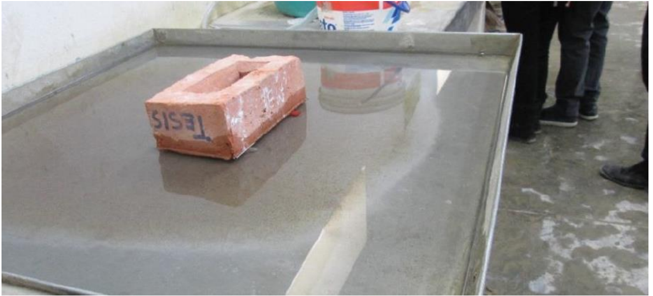
Foto 9 Ensayo de absorción del ladrillo
