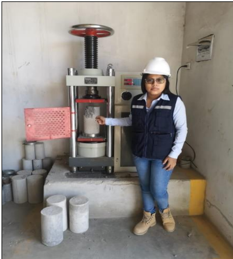
Demostración de ensayos de compresión en laboratorio.
