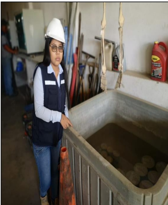
Curado de probetas para muestras
