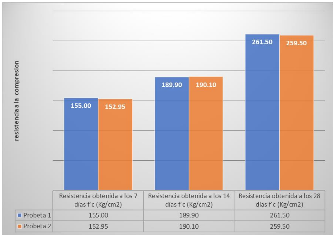
Gráfico 5. Mezcla de concreto con 12 kg/m 3 de polímero de carbono
