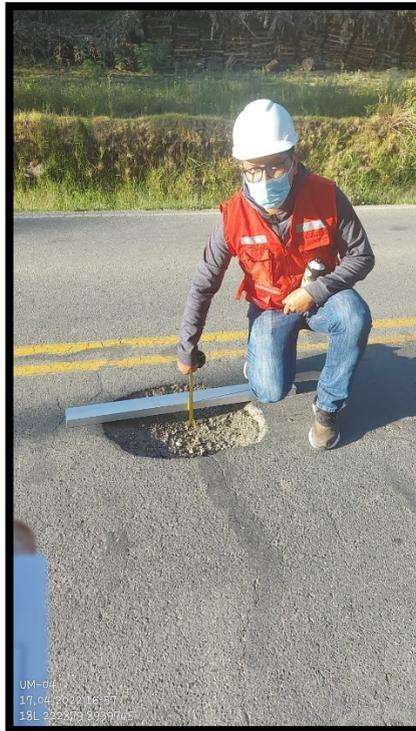
*Fotografía N° 05: Medición de las dimensiones del hueco generado en la vía y determinar el grado de severidad de los daños.*
