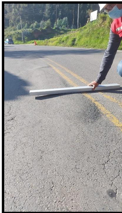
*Fotografía N° 04: Medición de la deformación longitudinal y transversal presente en el pavimento flexible para determinar el impacto de los daños.*
