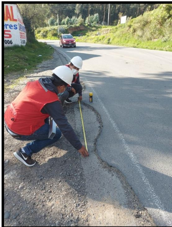
*Fotografía N° 02: Medición de las grietas de borde en la unidad de muestra en estudio.*
