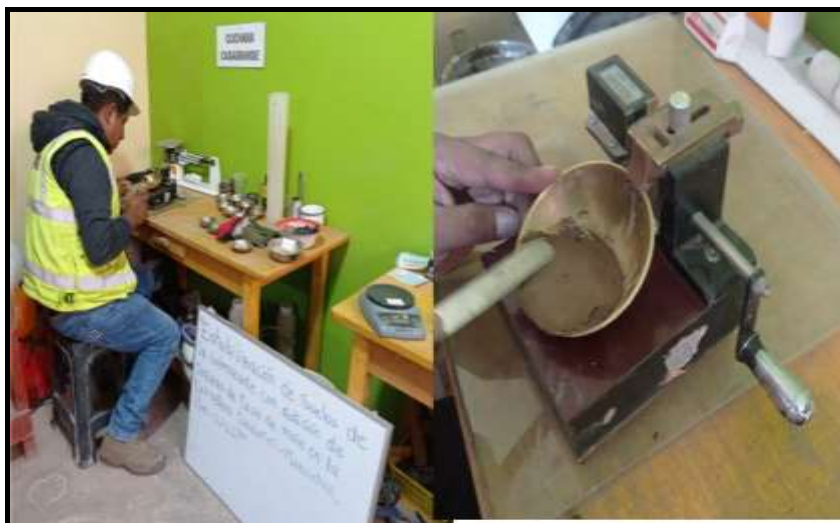
Figura 15: Determinando el límite líquido de un suelo con método de Casagrande
